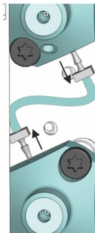
Illustration 62: Conduite de rinçage des joints d'interconnexion entre les têtes des dispositifs de mesure (échantillonneur à débit divisé double)
