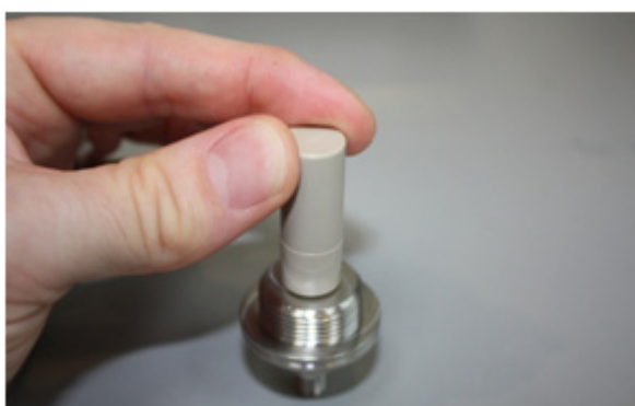
图 58. 安装活塞密封（PLF 泵）
