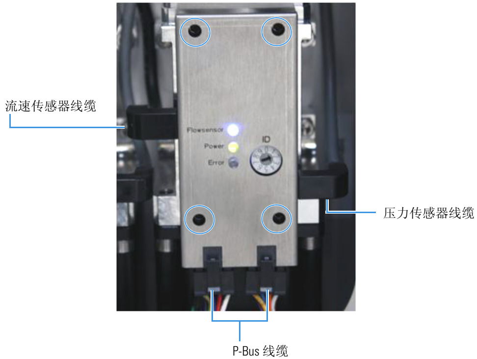
图 178. 四个 PCB 挡板螺钉（PLU 泵）
