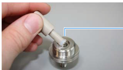
图 5. 利用活塞密封工具移除已磨损的活塞密封
