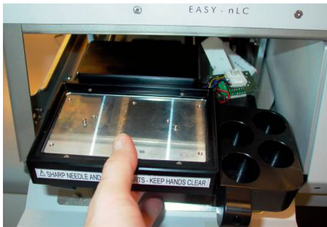
图 156. 将转接板支架拉出自动进样器
