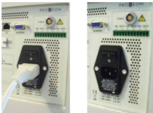
图 46. 从仪器的电源插座上移除电源线
