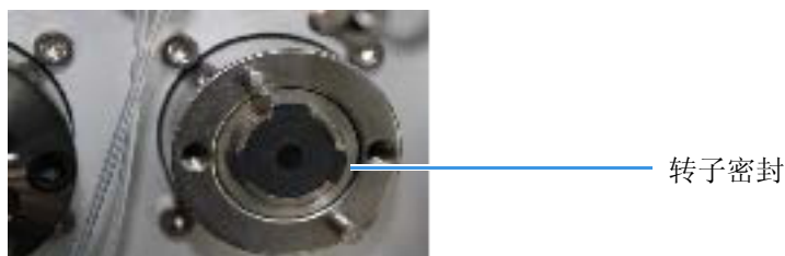
图 70. 安装在阀驱动器上的转子密封
