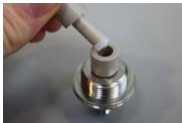
图 8. 将活塞密封工具插入导向工具
