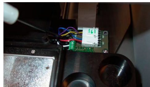
图 154. 拧松左侧中间的螺钉
