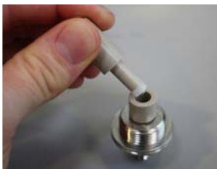
图 57. 将活塞密封工具插入导向工具（PLF 泵）
