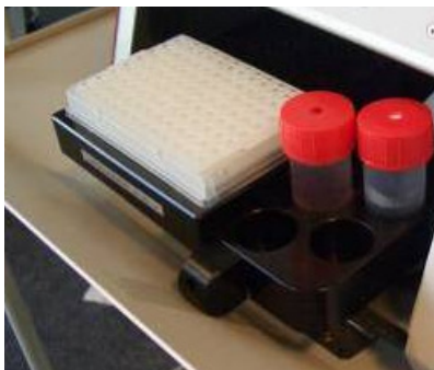
图 244. 显示了 ASA 型自动进样器的托盘室
