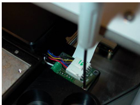
图 154. 拧松左侧中间的螺钉
