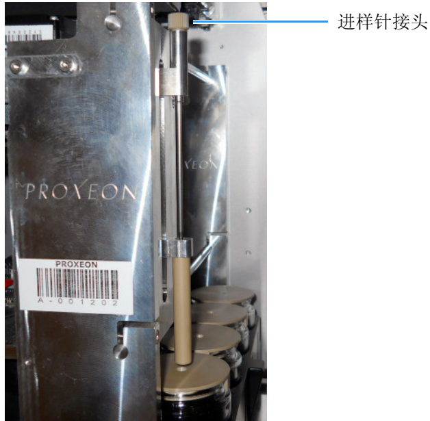
图 116. 针支架上连接的进样针
