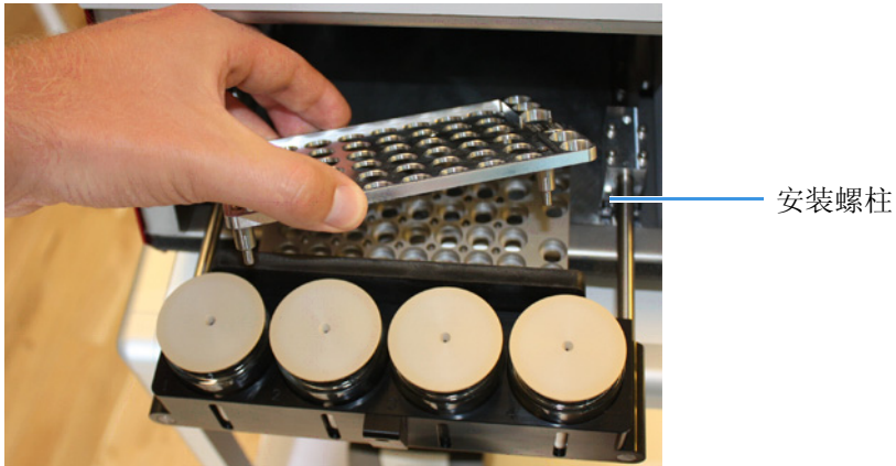
图 243. 在安装微孔板转接板之前移除样品瓶转接板
