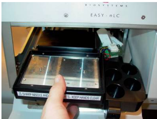
图 159. 将新冷却器放入自动进样器基座
