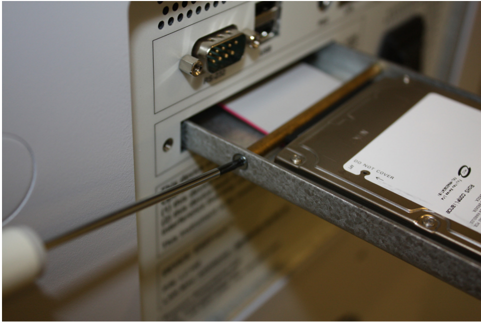
图 98. 移除压住连接线的黄铜棒
