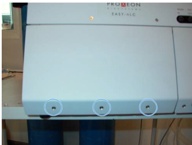
图 148. EASY-nLC II 仪器前面的螺钉（型号 LC 100-2）
