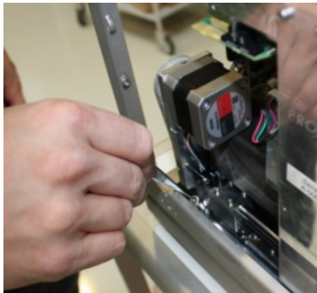
图 121. 移除自动进样器右侧的螺钉
