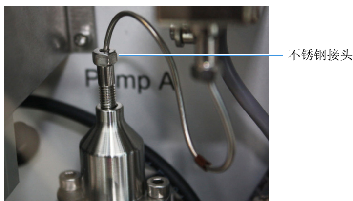
图 60. 不锈钢接头连接着泵头 (PLU 型号泵)
