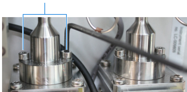
图 61. 使用 3 mm 内六角扳手移除泵头
