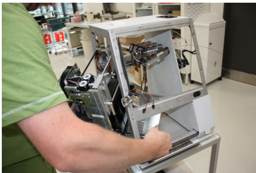
图 127. 放入 ASC 自动进样器
