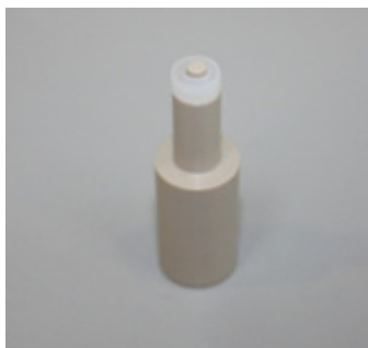
图 56. 活塞密封被置于活塞密封工具上（PLF 泵）
