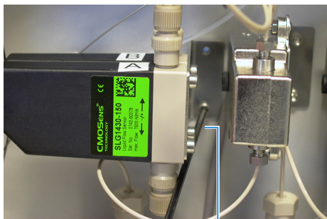
图 173. 移除将流速传感器支架固定到面板的两个螺钉
