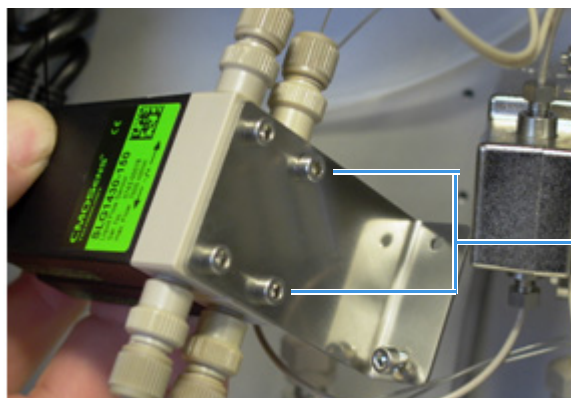
图 175. 从流速传感器支架上移除的流速传感器
