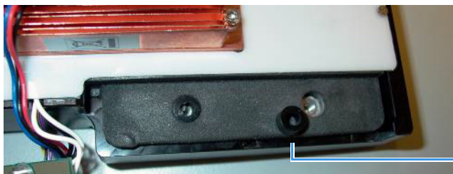
图 157. 转接板支架底部的孔套圈
