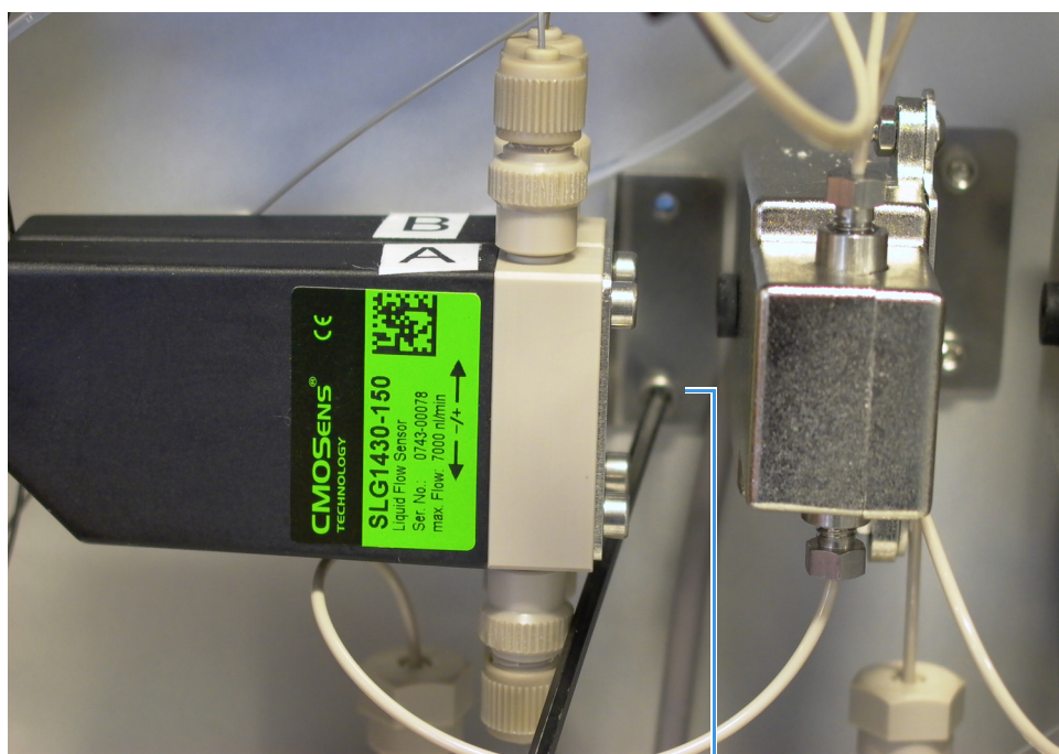
图 89. 移除将流速传感器支架固定到面板的两个螺钉
