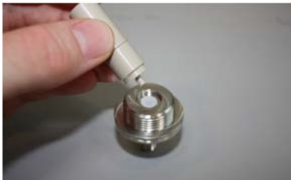
图 59. 活塞密封准确地安装到泵头（PLF 泵）
