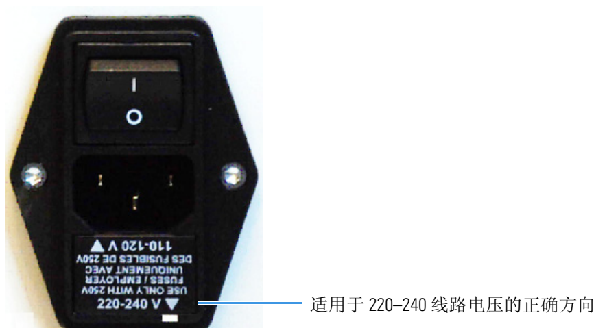
图 48. 电源输入模块
