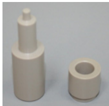
图 4. PLF 型号泵的两组件活塞密封工具
