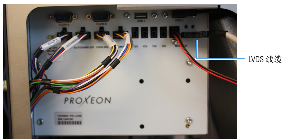
图 99. EASY-nLC 1000 仪器内连接机箱的线缆
