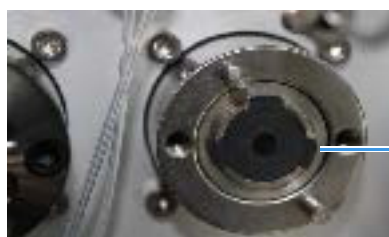
图 68. 安装在阀驱动器上的转子密封
