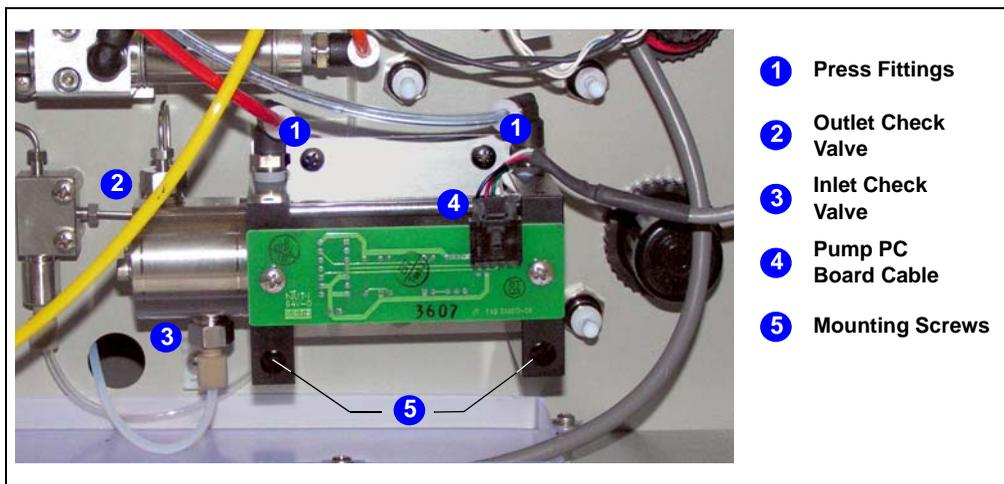
Figure 5-7. Dionex ASE 150 Pump (Behind Right-Side Panel)
