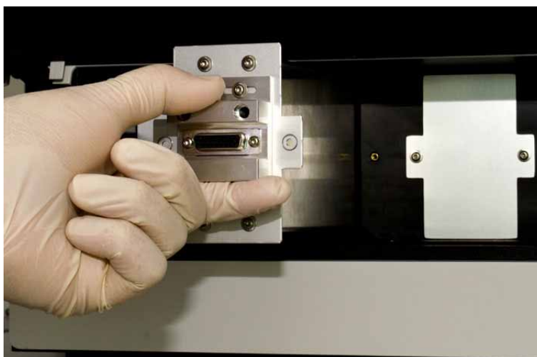
Fig. 32: Inserting potentiostat module
