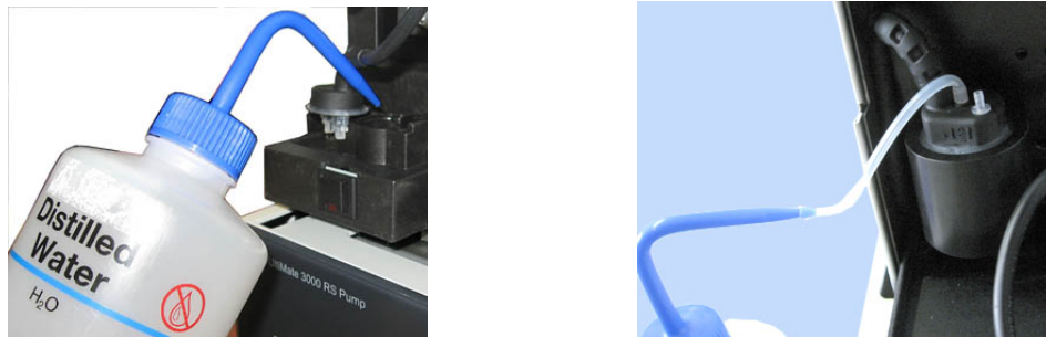
Abb. 10: Befüllen der Hinterspülung (Beispiele) (links: RS-/SD-/BM-Pumpe; rechts: NCS-3x00RS)
