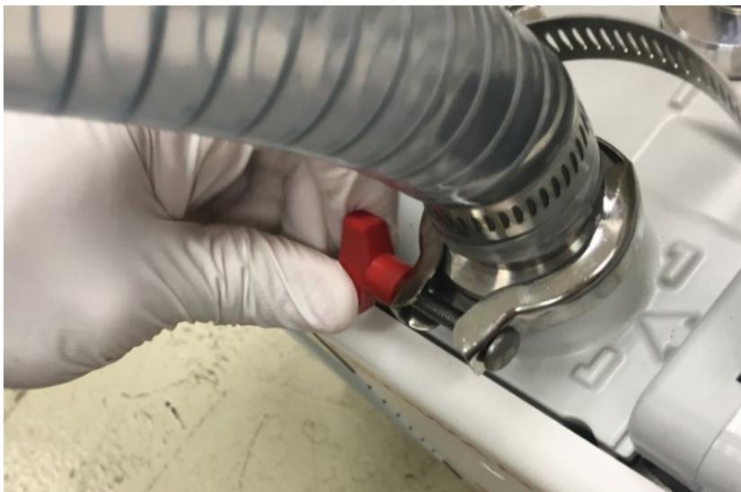
*Abbildung 21: Anbringen der Klemme für den Abluftschlauch*
