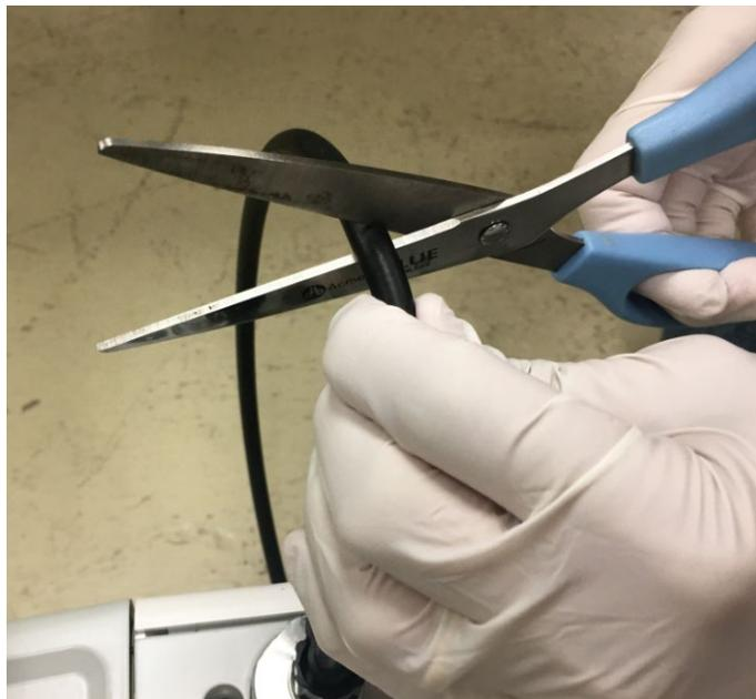
Abbildung 28: Zuschneiden des Schlauchs
