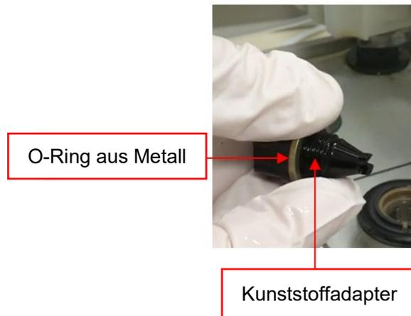
Abbildung 9: Anbringen des O-Rings aus Metall am Kunststoff-Gasballastadapter
