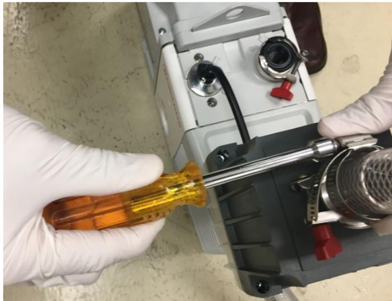
*Abbildung 35: Festziehen der Klemme mit einem Steckschlüssel*
