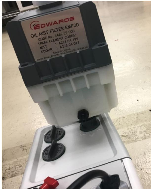
Abbildung 26: Installieren des Ölnebelfilters auf dem Adapter
