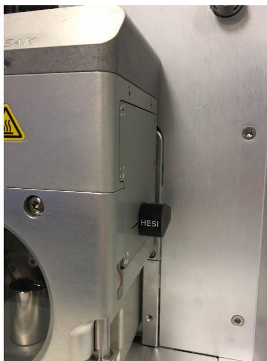
*Abbildung 50: Sicherstellen, dass sich das ISQ EM Quellengehäuse im HESI-Modus befindet*
