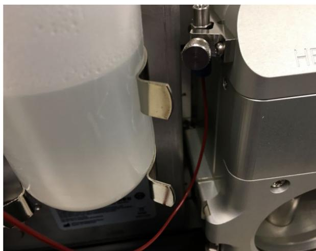
Abbildung 49: Wiederbefestigung des PEEK-Kapillarschlauchs an der Erdungsverbindung
