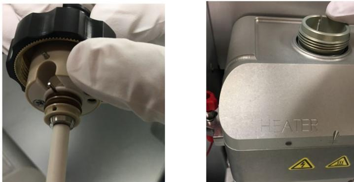
Abbildung 96: Ausrichtung des Stifts an der Zerstäubersonde zum Quellengehäuse
