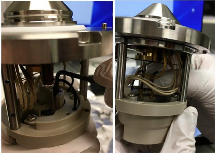
*Abbildung 117: Entfernung des PEEK-Teils zwischen den Schaltdrähten*
