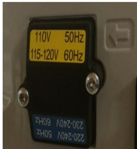
*Abbildung 5: Spannungseinstellungen der Edwards Vorpumpe*
