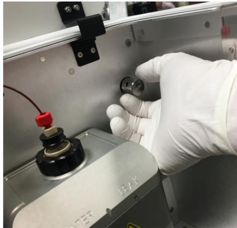
*Abbildung 90: Entlüften des Massenspektrometers*
