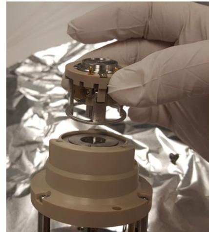
*Abbildung 112: Entfernung der Q00/LO-Einheit*
