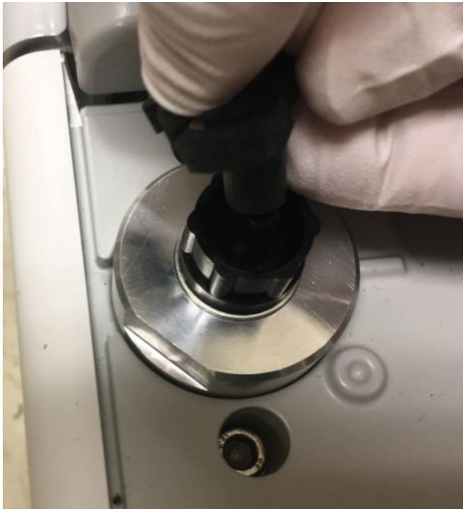
*Abbildung 18: Befestigen des Schlauchs des Ölnebelfilters an den Adapter*
