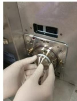
*Abbildung 47: Installation des Abtastkonus*
