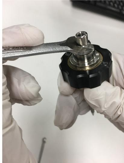
*Abbildung 99: Lösen der Mutter an der APCI-Sonde*
