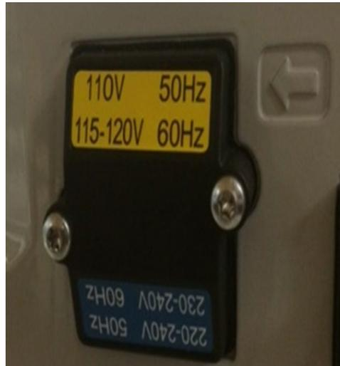
Abbildung 61: Spannungseinstellungen der Edwards Vorpumpe
