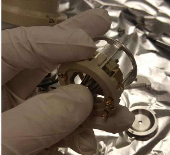
*Abbildung 115: Entfernen des Q00 aus dem Gestell*
