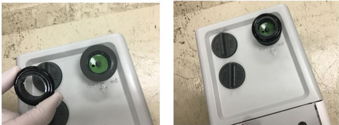
Abbildung 24: Installieren des Ölnebeladapters auf dem grauen Abluftanschlussadapter
