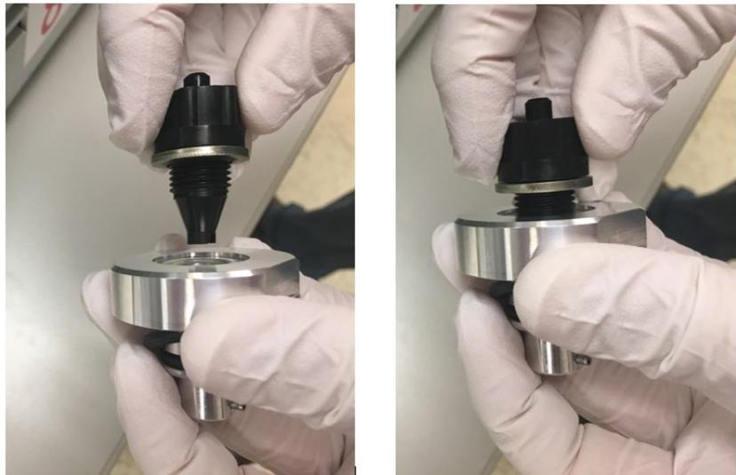
Abbildung 10: Zusammenschrauben der Adapter
