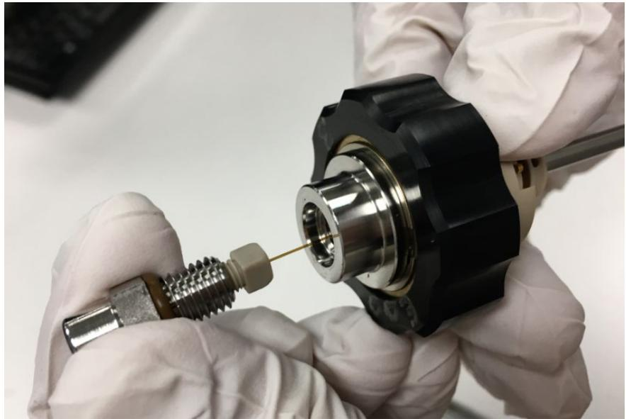
*Abbildung 100: Entfernung der Kapillare aus der APCI-Sondeneinheit*
