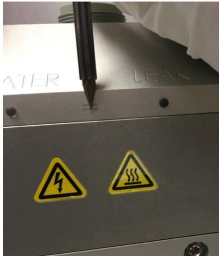
*Abbildung 94: Justierungsmarkierungen für die Kapillareinheit am Quellengehäuse*
