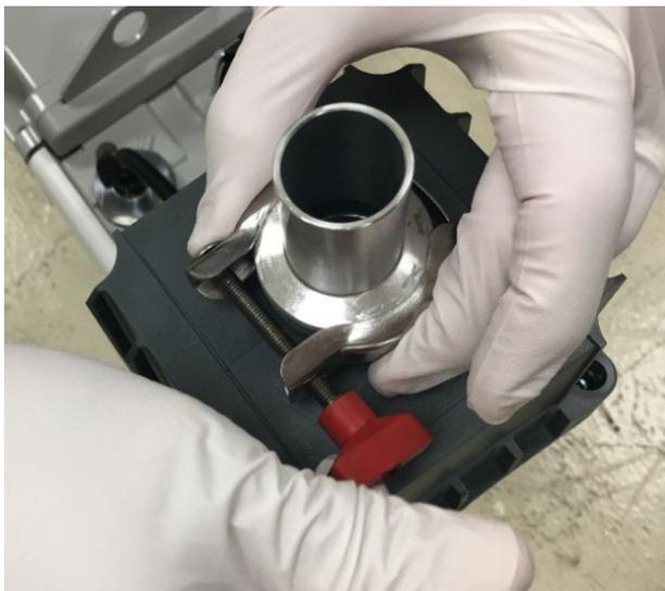
*Abbildung 33: Fixieren des oberen Adapters und O-Rings mit einer Klemme*
