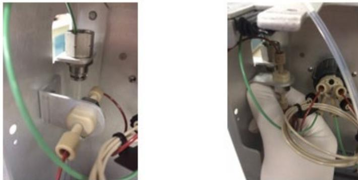
Abbildung 55: Verbindung zwischen LC und MS-Einlass
