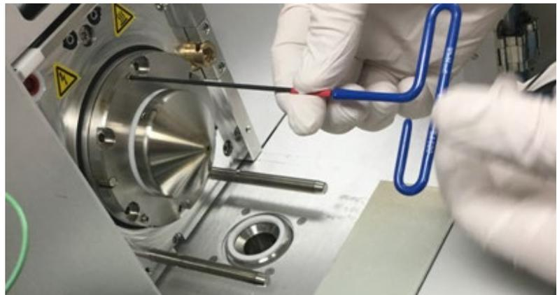
Abbildung 108: Festschrauben der Stellschrauben
