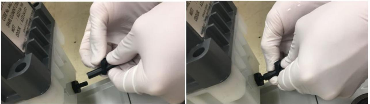
Abbildung 29: Befestigen des Pumpenabluftschlauchs an der Ölnebelfiltereinheit
