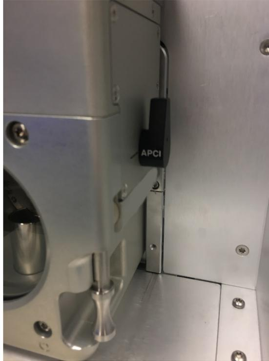
*Abbildung 51: Sicherstellen, dass sich das ISQ EM Quellengehäuse im APCI-Modus befindet*
