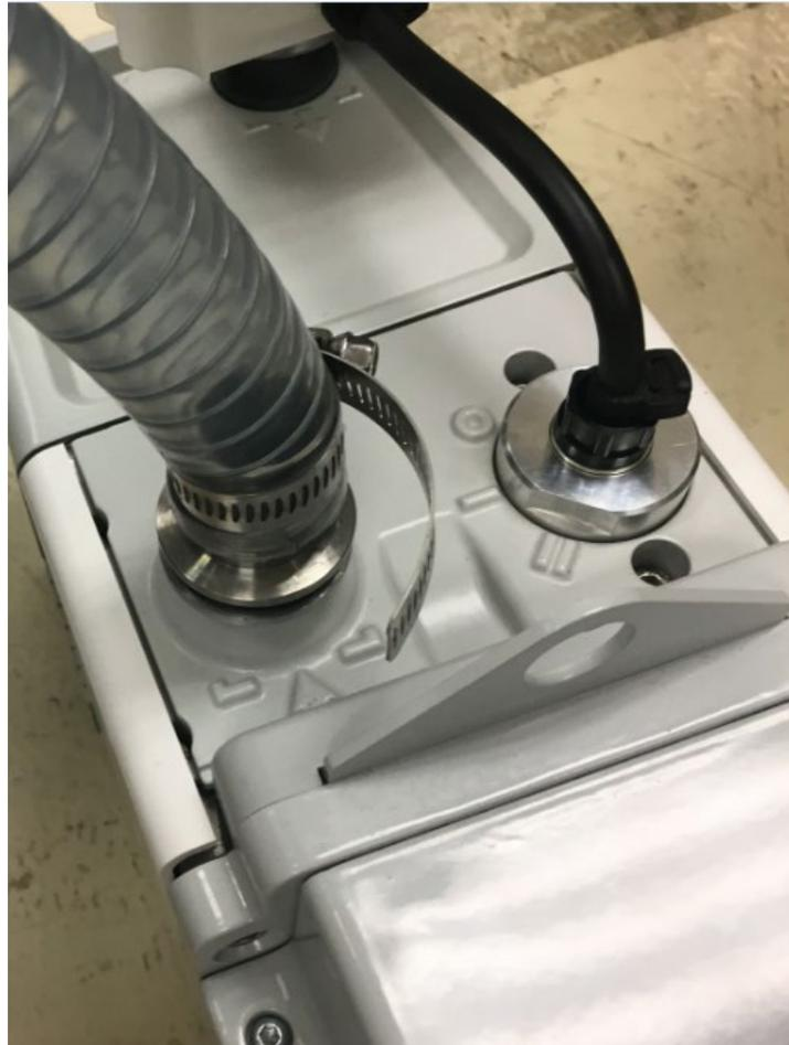
Abbildung 20: Anbringen des Vorpumpenschlauchs an der Vorpumpe
