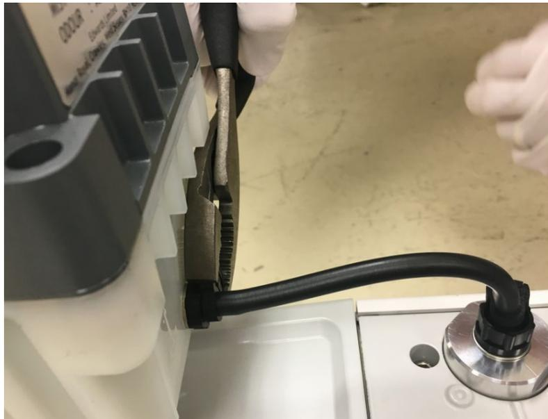
Abbildung 30: Festziehen der Klemme des kleinen Schlauchs der Ölnebelfiltereinheit
