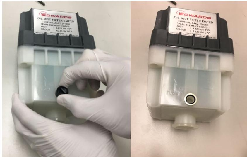
Abbildung 22: Entfernen des Stopfens vom Ölnebefilter
