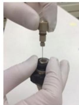
*Abbildung 93: Entfernung der Kapillare aus der ESI-Sondeneinheit*
