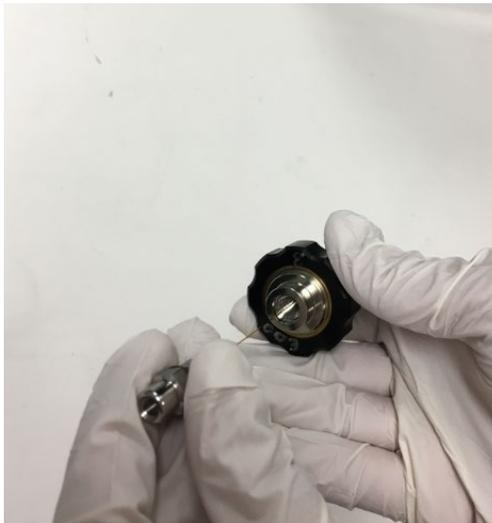
*Abbildung 103: Schrauben der Kapillareinheit in die APCI-Sonde*
