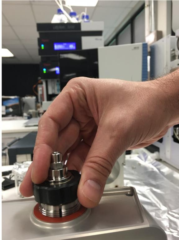
*Abbildung 98: Entfernung der APCI-Sondeneinheit*
