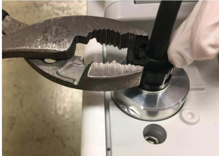
*Abbildung 19: Festziehen der Klemme mit einem Werkzeug*
