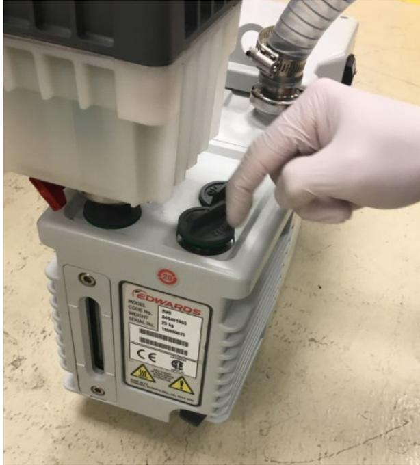
Abbildung 38: Abschrauben des Ölbehälterdeckels
