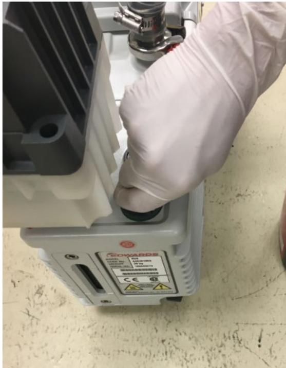
Abbildung 40: Schließen und Festziehen des Ölbehälterdeckels
