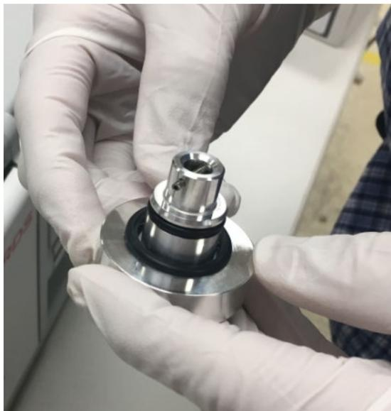
*Abbildung 8: Befestigen des großen O-Rings an der Basis des Metall-Gasballastadapters*
