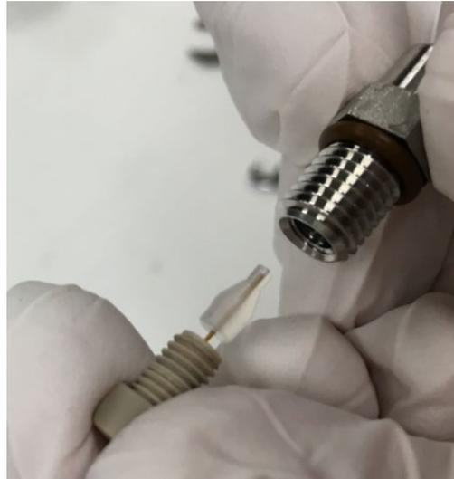
*Abbildung 102: Entfernung der durchsichtigen Quetschhülse und der PEEK-Kapillare*
