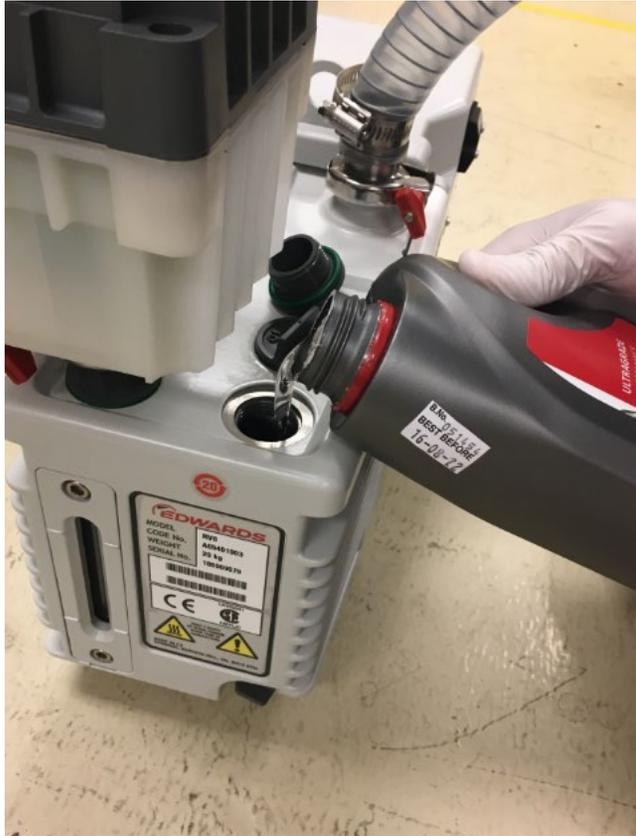
Abbildung 39: Einfüllen von Öl in die Vorpumpe
