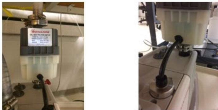
Abbildung 36: Vorpumpen-Ölnebelfiltereinheit und Ölrückführkit
