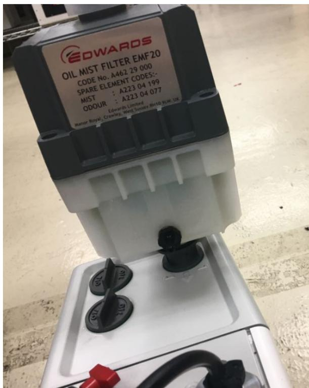
Figure 26 : installation du filtre à brouillard d'huile dans l'adaptateur
