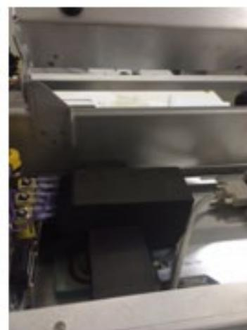
Figure 3 : Module d'alimentation électrique et emplacement de la mousse du collecteur
