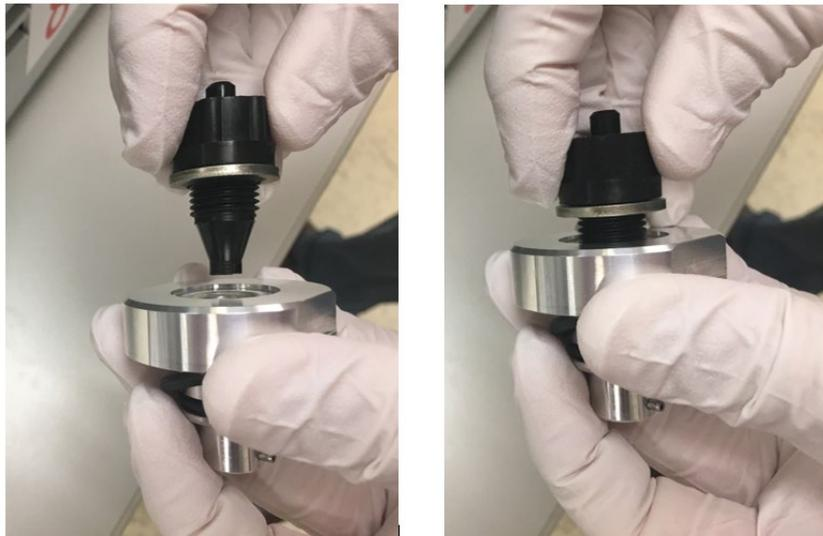
Figure 10 : Vissage des adaptateurs l'un dans l'autre
