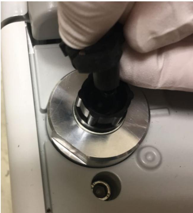
Figure 18 : Fixation du tuyau du filtre à brouillard d'huile sur l'adaptateur
