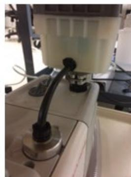
Figure 36 : filtre à brouillard d'huile de la pompe primaire et kit de retour d'huile
