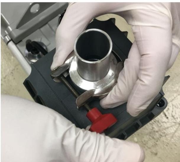
Figure 33 : fixation de l'adaptateur et du joint torique supérieurs à l'aide d'un collier
