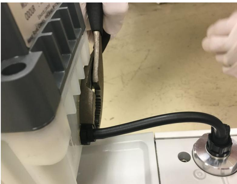
Figure 30 : serrage du petit collier de serrage du filtre à brouillard d'huile
