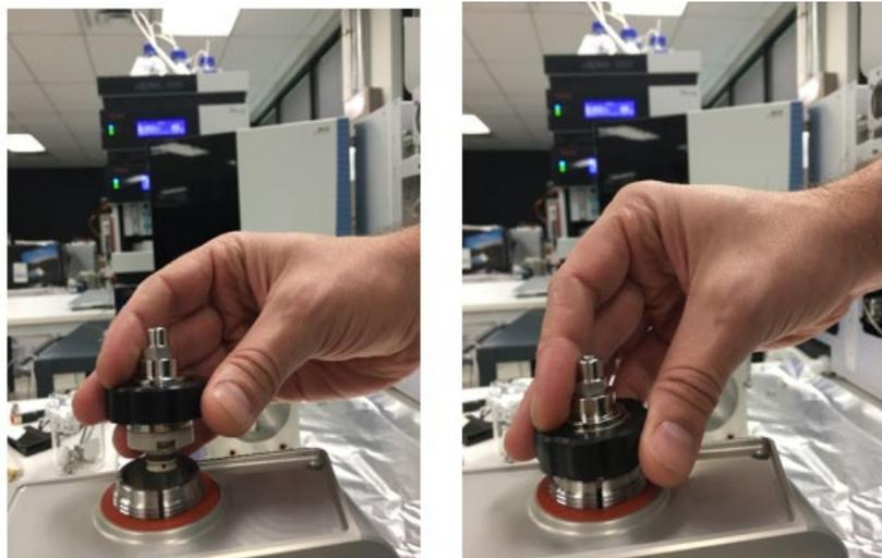
Figure 104 : alignement de la broche sur la sonde APCI avec l'enceinte de la source
