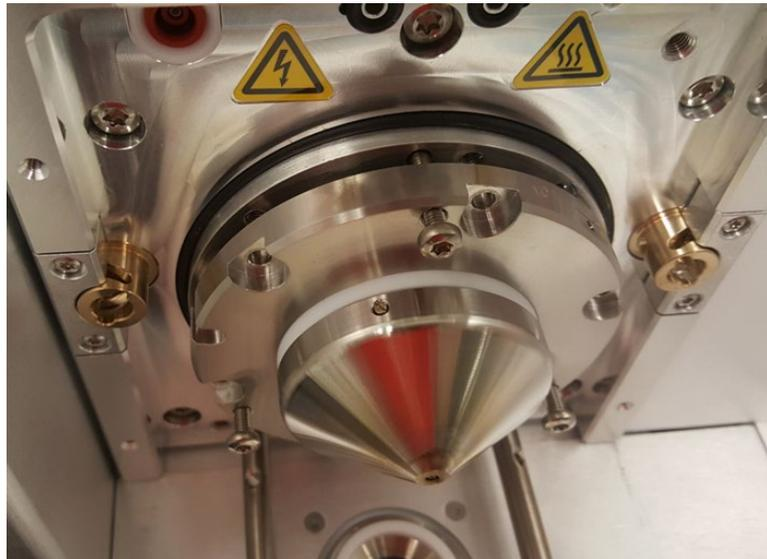
Figure 109 : Vue du système optique frontal avec joint rompu
