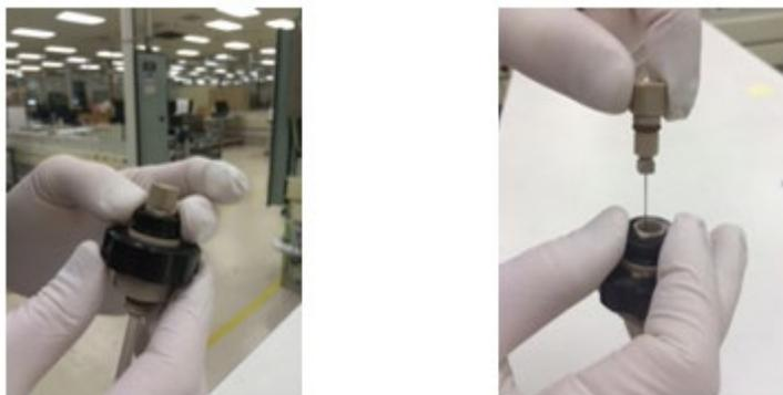
Figure 93 : Retrait du capillaire de la sonde ESI
