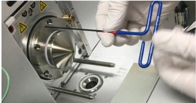
Figure 108 : Insertion des vis de réglage
