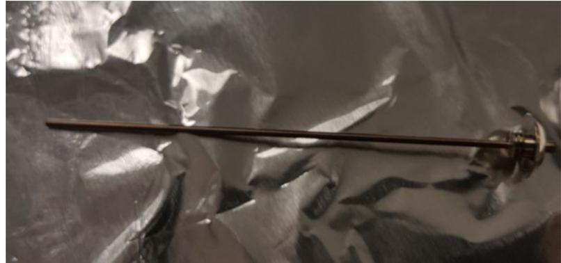
Figure 111 : Retrait du tube de transfert ionique
