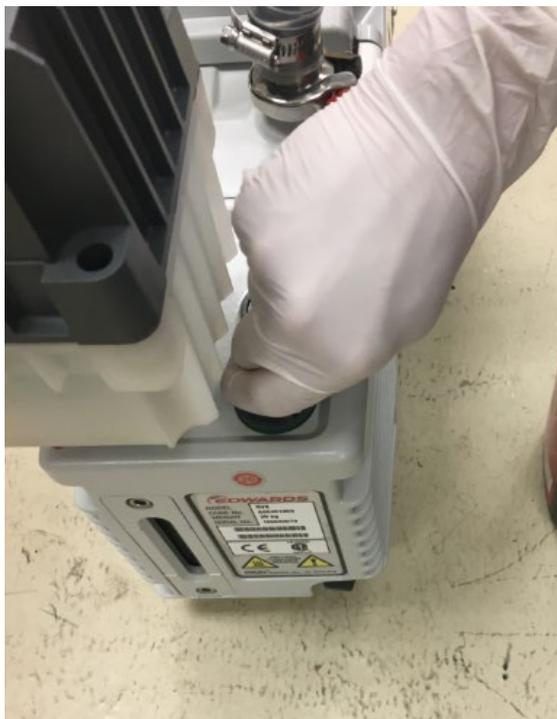
Figure 40 : fermeture et serrage du bouchon du réservoir d'huile
