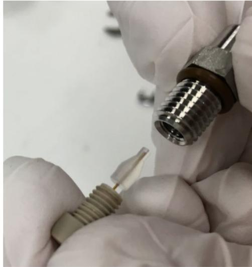
Figure 102 : retrait de la ferrule claire et du capillaire PEEK
