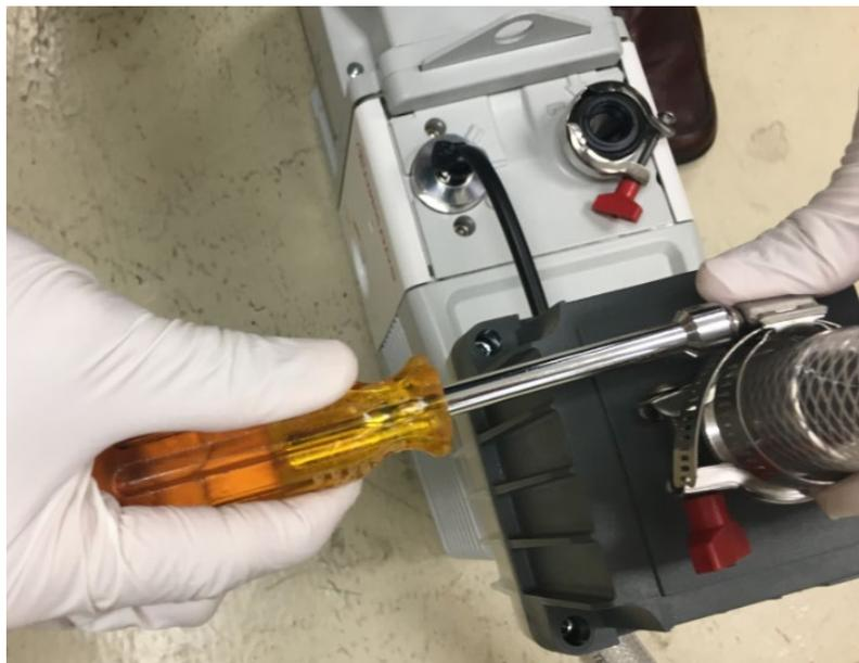
Figure 35 : serrage du collier à l'aide d'un tournevis à douille
