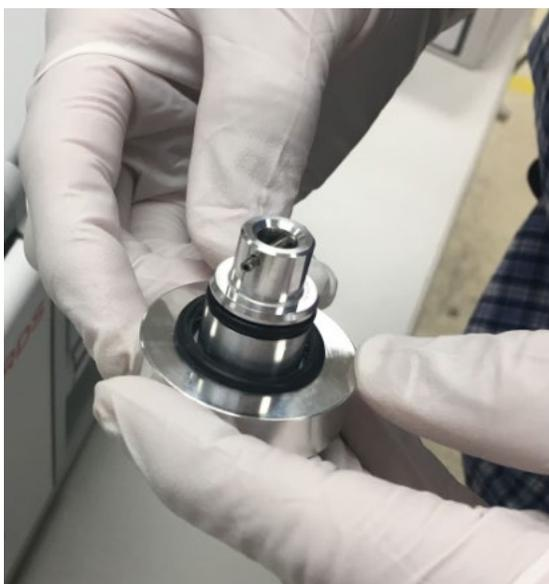
*Figure 8 : fixation du grand joint torique sur l'adaptateur de lest d'air en métal*
