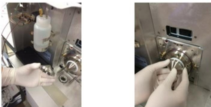
Figure 47 : Installation du cône de balayage
