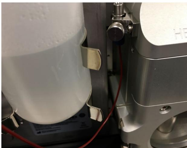
*Figure 49 : Refixez le tuyau capillaire en PEEK à la jonction de mise à la terre*
