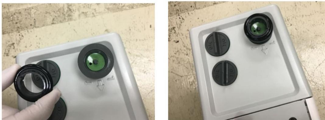
Figure 24 : installation de l'adaptateur du filtre à brouillard d'huile sur l'adaptateur du port d'échappement gris
