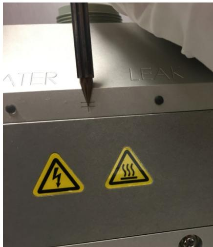
Figure 94 : Marques d'alignement de l'ensemble capillaire sur l'enceinte de la source
