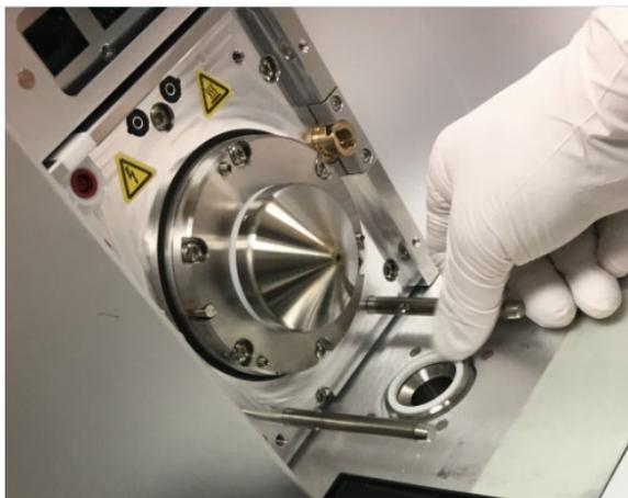
*Figure 48 : Réinstallation de l'enceinte de la source*
