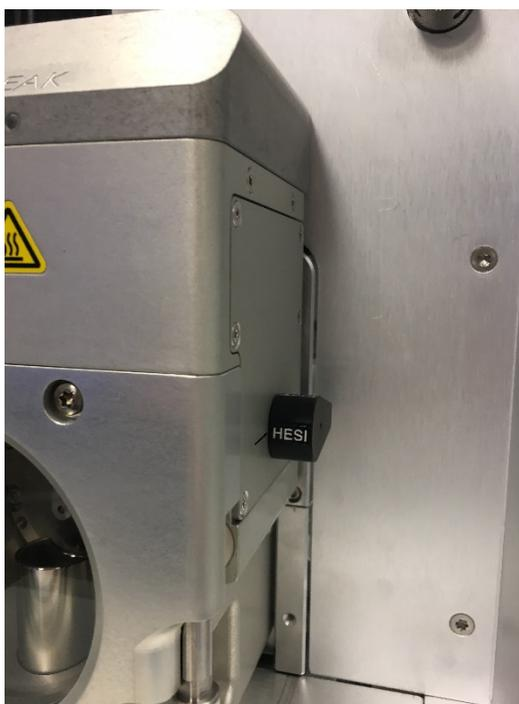
*Figure 50 : vérification du mode HESI sur l'enceinte de la source ISQ EM*
