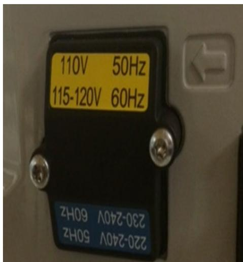
Figure 61 : Réglage de la tension de la pompe primaire Edwards
