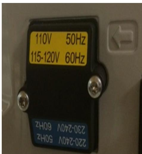
Figure 5 : Réglage de la tension de la pompe primaire Edwards
