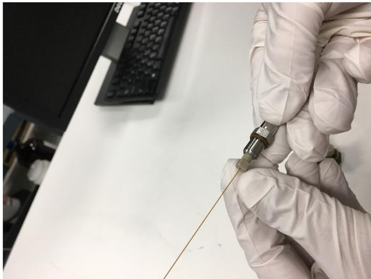
Figure 101 : retrait du raccord PEEK
