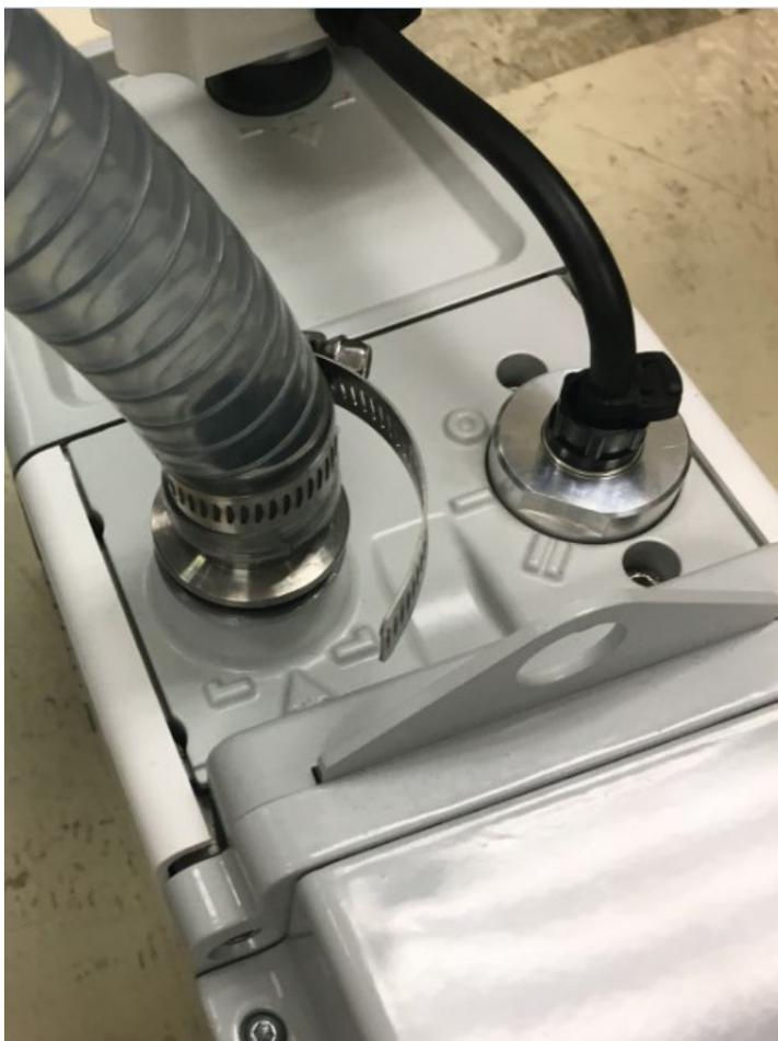
Figure 20 : installation du tuyau primaire dans la pompe primaire
