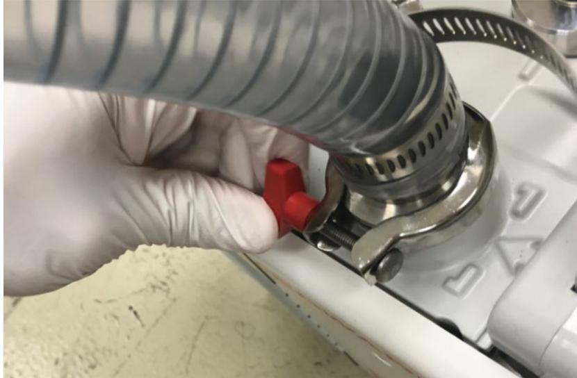
*Figure 21 : installation du collier pour le tuyau d'évacuation*
