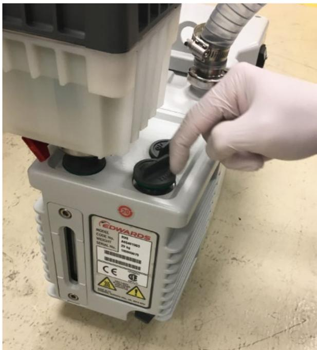
Figure 38 : dévissage du bouchon du réservoir d'huile
