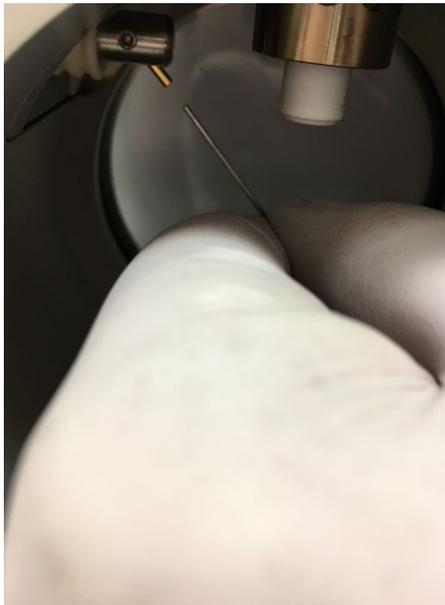
Figure 106 : retrait et installation de l'aiguille APCI
