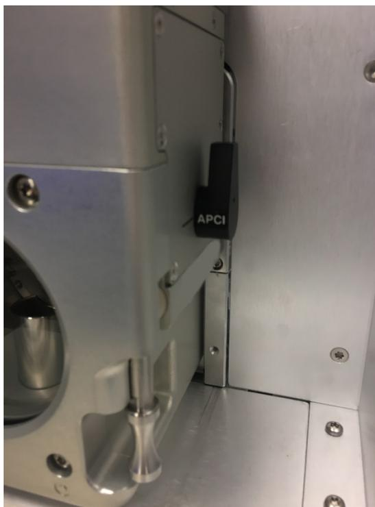
*Figure 51 : vérification du mode APCI sur l'enceinte de la source ISQ EM*
