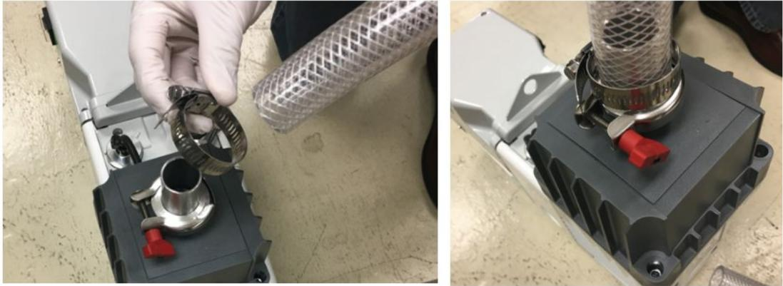
Figure 34 : installation du collier de serrage et du tuyau sur l'adaptateur supérieur
