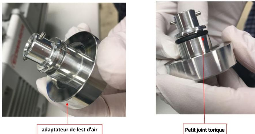
*Figure 6 : ajout du petit joint torique sur l'adaptateur de lest d'air*
