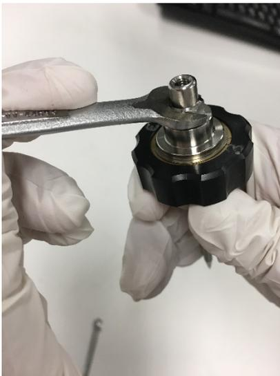
Figure 99 : desserrage de l'écrou sur la sonde APCI
