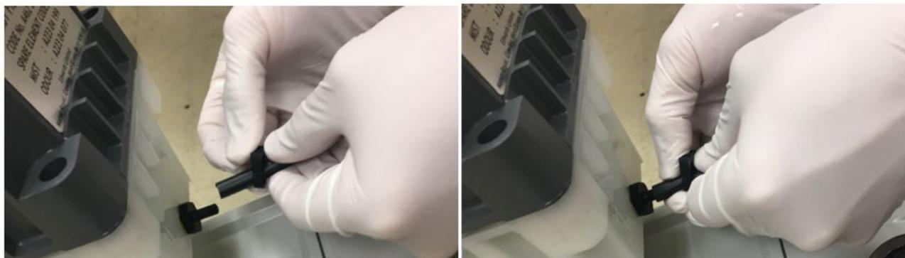
Figure 29 : fixation du tuyau d'évacuation de la pompe au filtre à brouillard d'huile
