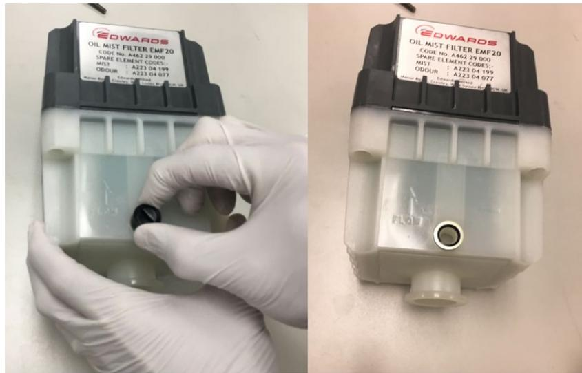
Figure 22 : retrait du bouchon du filtre à brouillard d'huile.
