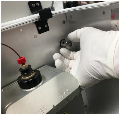
*Figure 90 : Ventilation du spectromètre de masse*
