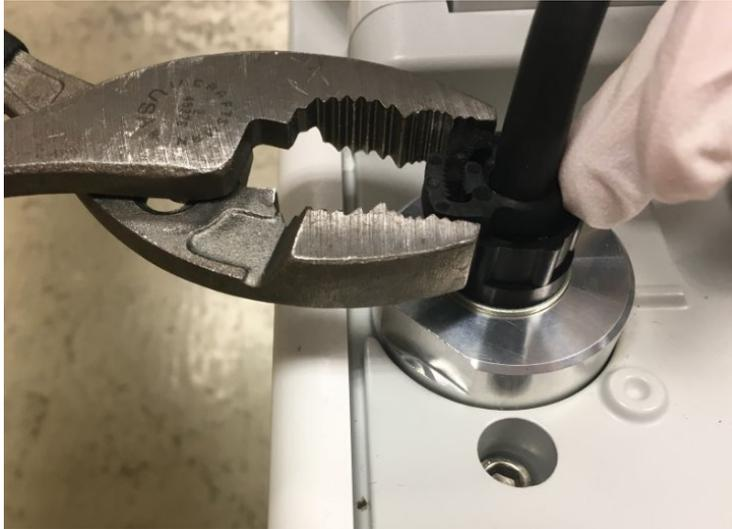
*Figure 19 : serrage du collier à l'aide d'un outil*
