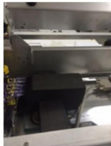
图 3：电源模块和歧管泡沫件位置
