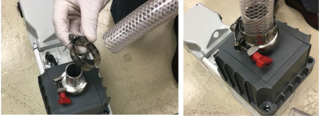
图 34：将软管夹钳和软管安装在顶部适配器上
