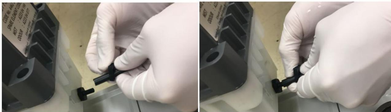
图 29：将泵排气软管连接到油雾过滤器组件
