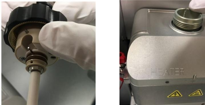
图 96：将喷雾探针上的销与源外壳对齐
