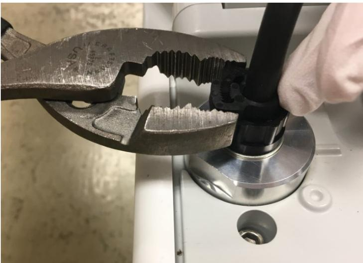
图 19: 用工具拧紧夹钳
