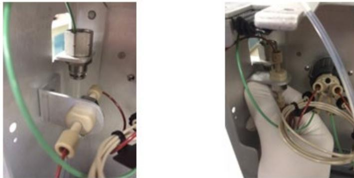
图 55: LC 到 MS 进样口
