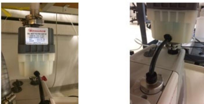
图 36：前级泵油雾过滤器组件和回油包
