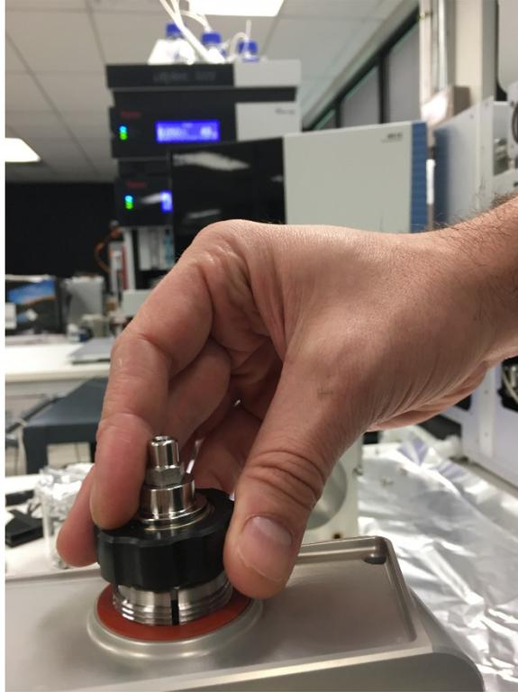
图 98：拆除 APCI 探针组件
