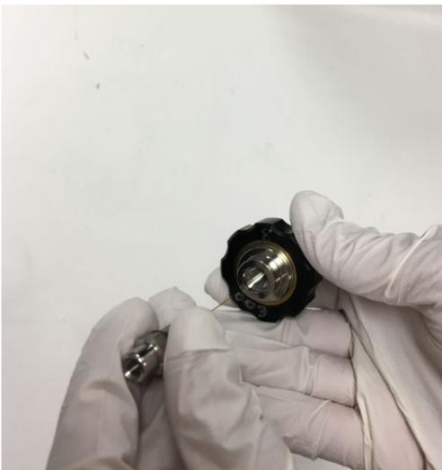
图 103：将毛细管组件旋入 APCI 探针
