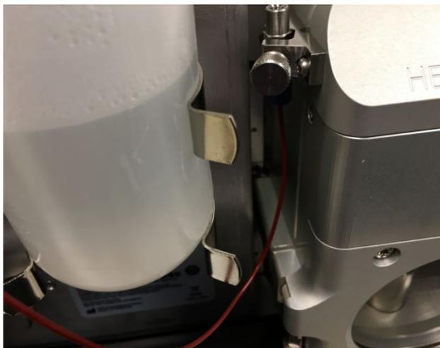
图49：重新将 PEEK 管连接到接地接头上
