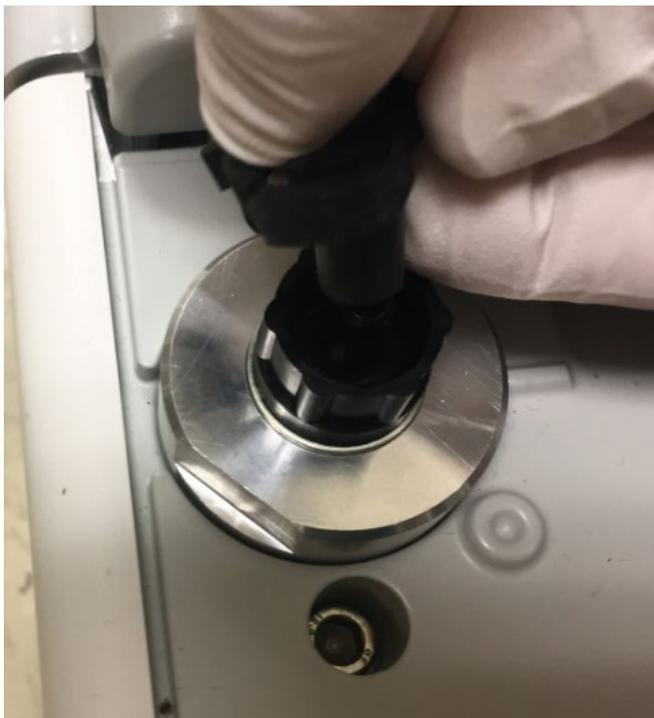
图 18：将油雾过滤器软管连接到适配器
