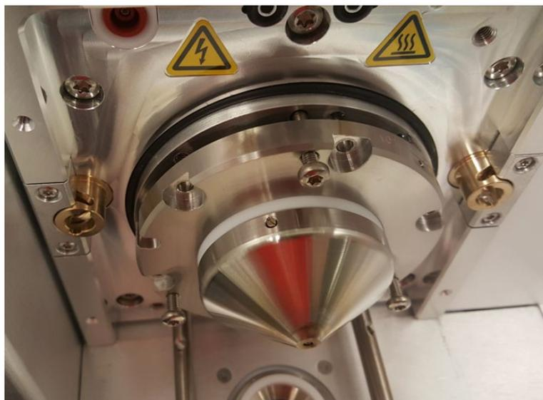
图 109：前侧光学元件视图，密封已破坏
