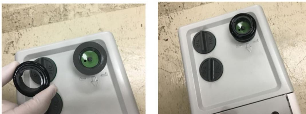
图 24：在灰色排气口适配器上安装油雾过滤器适配器
