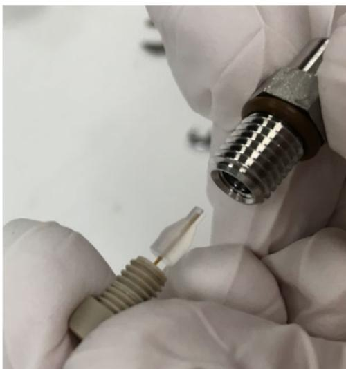
图102：取下透明金属箍和PEEK 毛细管
