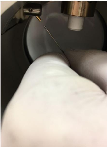
图 106：拆卸和重新安装 APCI 针头
