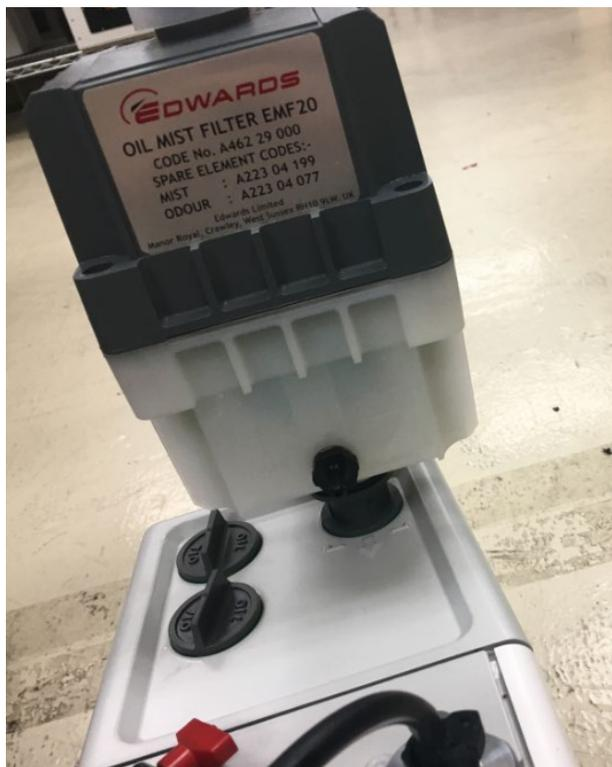
图 26: 将油雾过滤器安装到适配器上
