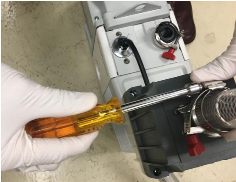
图 35：用螺母驱动器拧紧夹钳
