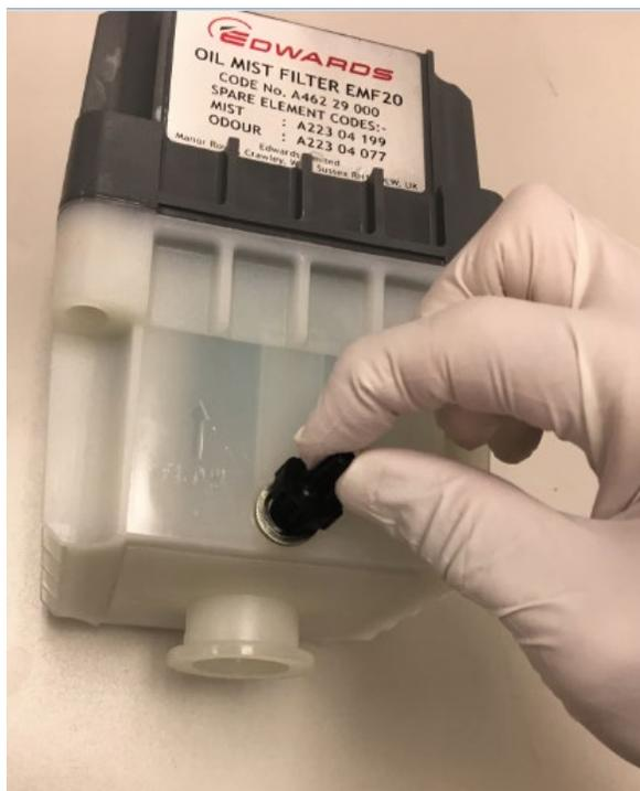
图 23：安装紧贴型软管适配器
