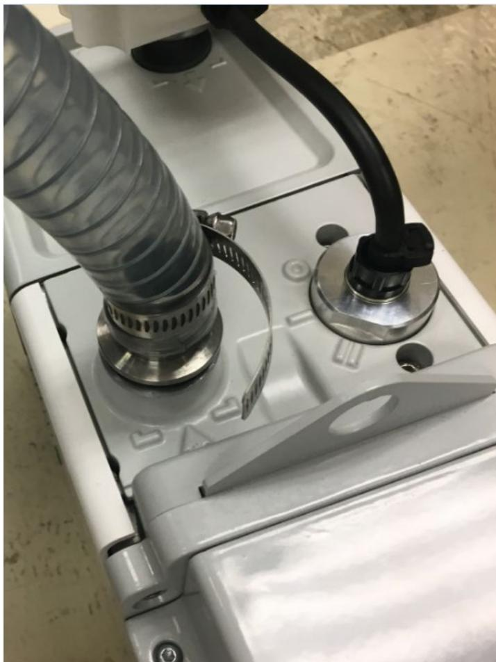
图 20: 将前级软管安装到前级泵
