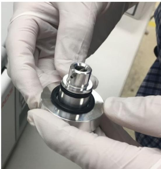
图 8: 将大 O 形环装到金属气镇适配器上
