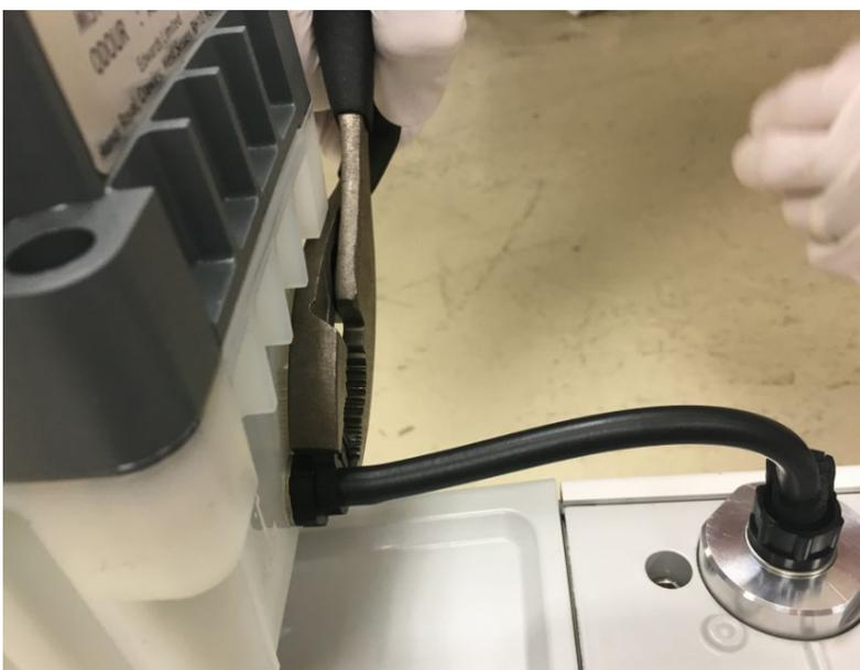
图 30：拧紧油雾过滤器组件小软管夹钳
