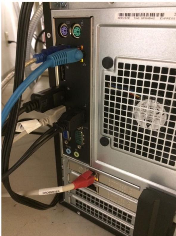
图 59: 将 ISQ EC MS 连接到计算机
