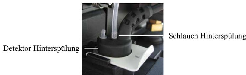
Abb. 21: Schlauchverbindung am Detektor
