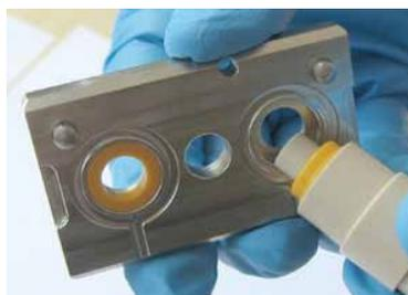
Abb. 55: Einsetzen des Dichtrings in die Platte der Hinterspülung
