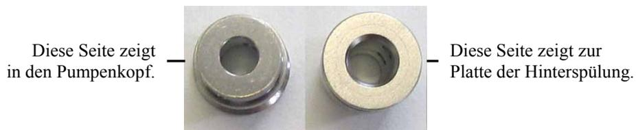
Abb. 49: Ausrichtung Hinterspülung
