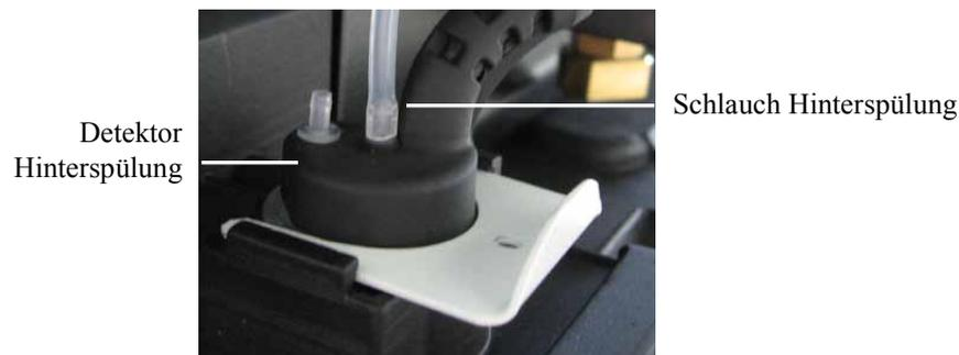
Abb. 39: Schlauchverbindung am Detektor der Hinterspülung
