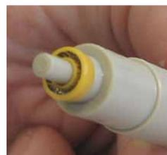
Abb. 47: Ausrichtung des Kolbendichtrings (hier Reversed Phase)
