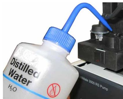
Abb. 19: Befüllen der Hinterspülung
