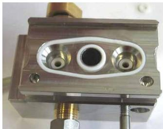
Abb. 48: Dichtring im Pumpenkopf eingesetzt
