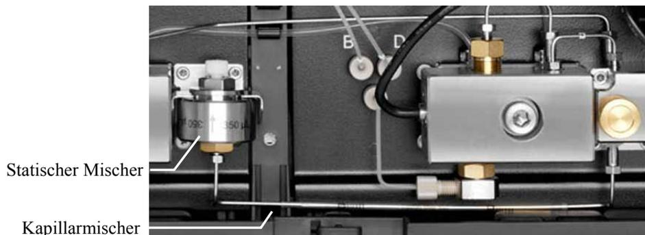
Abb. 5: Zweistufiges Mischersystem (hier in einer HPG-3400SD)
