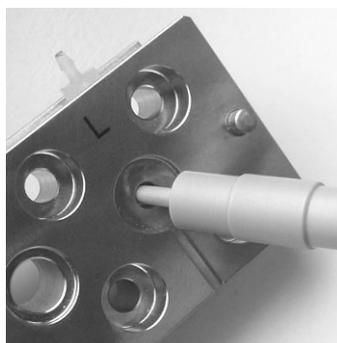
图 58: 拆下密封清洗密封圈
