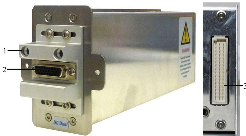
Abb. 6: Seiten- und Rückansicht eines Potentiostaten für DC-Modus
