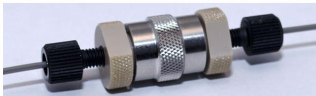
Abb. 17: Angeschlossener In-Line-Filter
