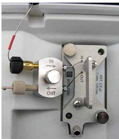
Abb. 38: Eingebaute Messzelle mit Eingangskapillare aus Edelstahl (hier: Viper-Kapillare)
