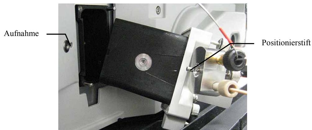
Abb. 37: Einbau einer Messzelle mit Adapterblock (hier: Semi-Mikro-Messzelle)
