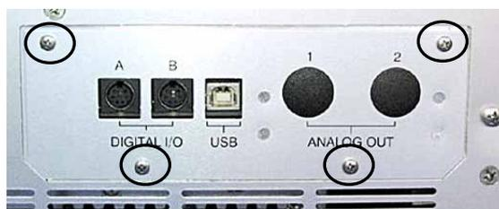
Abb. 11: Zu lösende Schrauben auf der Detektorrückwand
