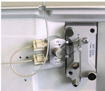
Abb. 39: Eingebaute analytische Messzelle mit Eingangskapillare aus PEEK
