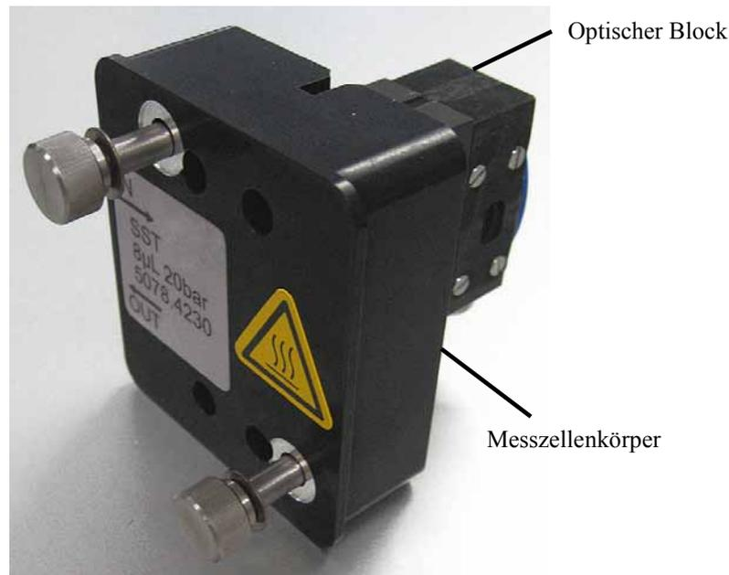
Abb. 15: Messzelle des Fluoreszenz-Detektors
