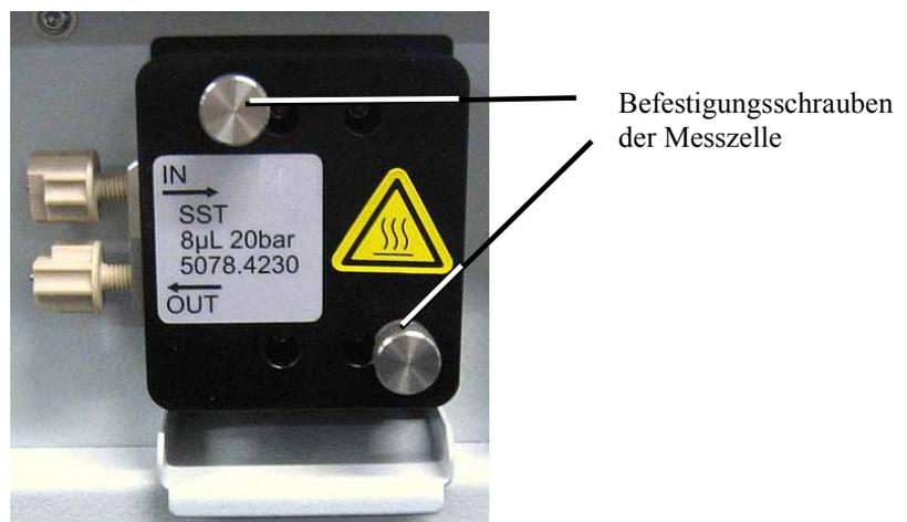
Abb. 38: Schrauben der Messzelle lösen
