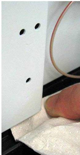
Abb. 40: Trocknen des Leaksensors
