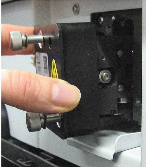
*Abb. 39: Einsetzen der Messzelle*
