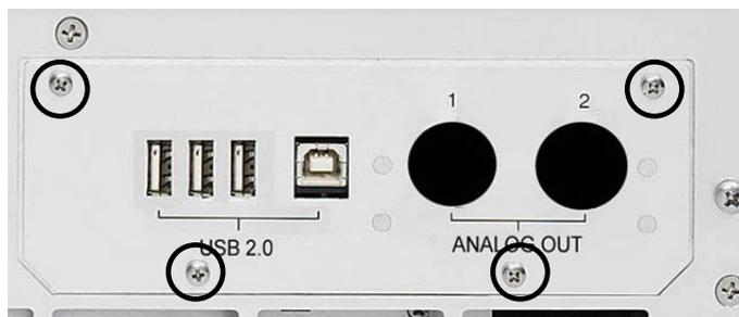
Abb. 4: Zu lösende Schrauben auf der Detektorrückwand
