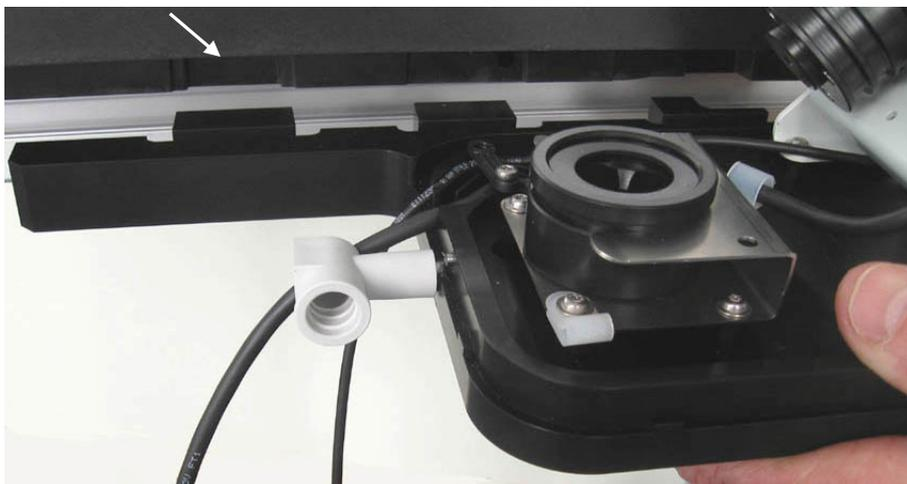
Abb. 8: Installieren des Messzellenträgers
