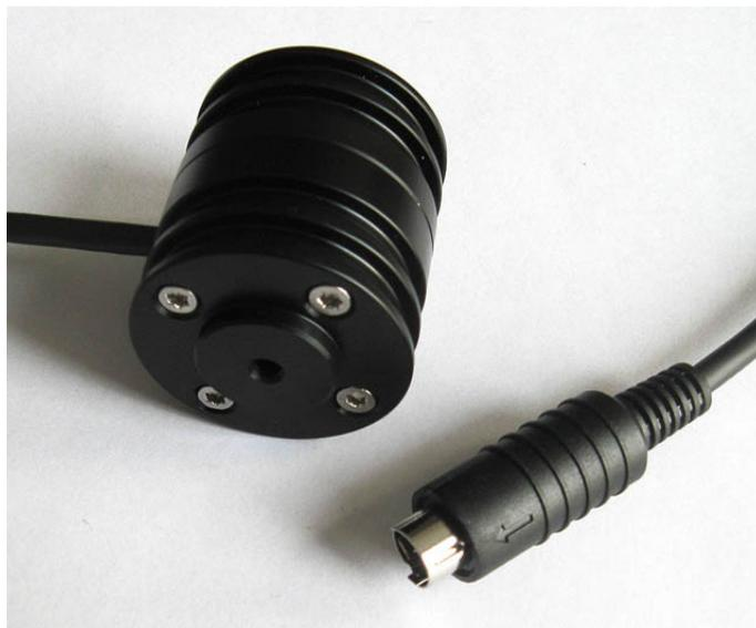
*Abb. 3: Leitfähigkeits-Messzelle mit Anschlusskabel*
