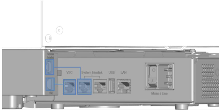
图 213: 连接 VSC system interlink 缆
