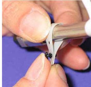
Abb. 20: Befestigen der Säulen-ID-Chipkarte an einer Säule
