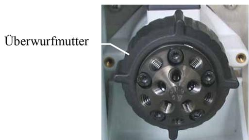
Abb. 48: Lösen der Überwurfmutter
