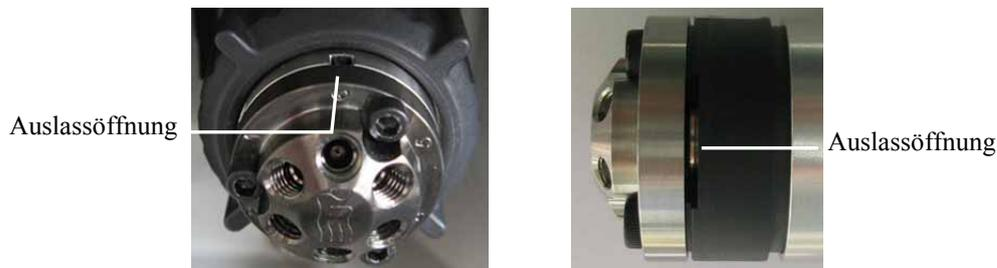
Abb. 45: Auslassöffnungen am Säulenschaltventil
