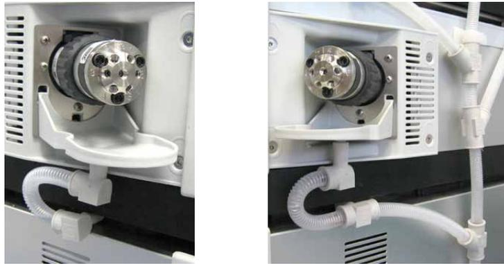
*Abb. 16: Drainagewanne mit Ablaufschlauch
