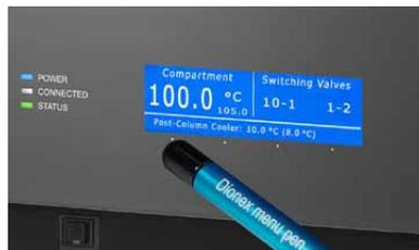
Abb. 35: Einblenden der Funktionstasten
