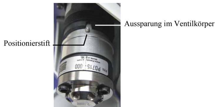
Abb. 47: Ausrichten des Ventil-Pods
