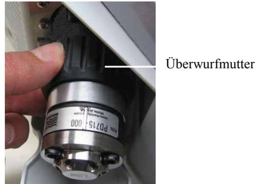
Abb. 46: Lösen der Überwurfmutter
