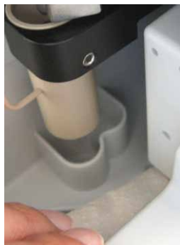
Abb. 40: Trocknen des Leaksensors
