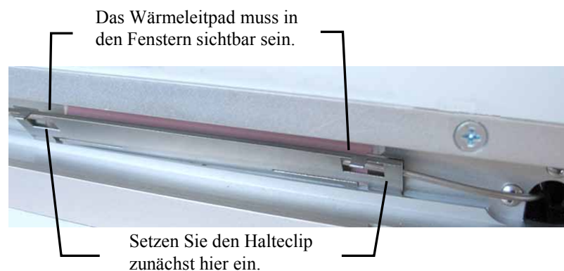
Abb. 57: Einsetzen des Halteclips
