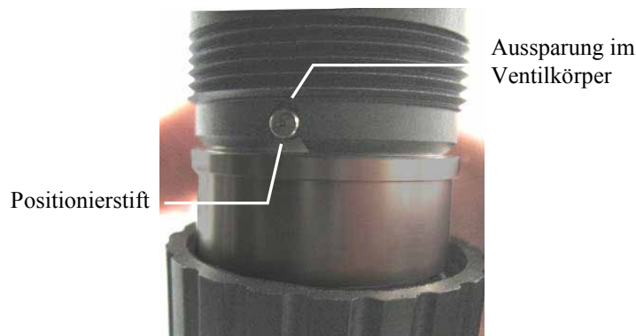
Abb. 50: Ausrichten des Positionierstifts
