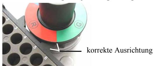
Abb. 24: Ausrichtung des Probenhalters im Drehteller
