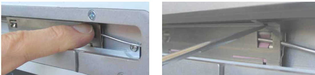
Abb. 58: Andrücken des Halteclips
