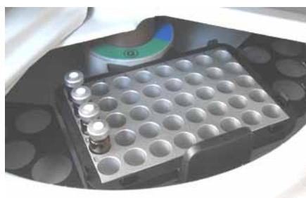
Abb. 23: Einsetzen des Probenhalters
