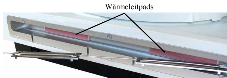
Abb. 56: Ausrichten der Halteclips
