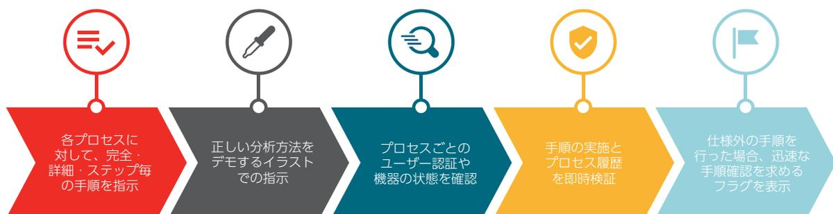
ラボ実行システム（LES）ソフトウェアは、SOPを確実に順守し、プロセスの履歴を確実に残すため、各処理の作業手順を管理・記録し表示するものです。
