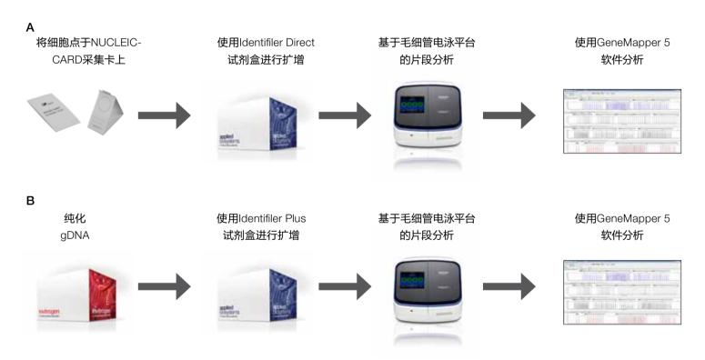
**图1.** 细胞系鉴定流程。两种方法可鉴定细胞系。(A) 将细胞点在NUCLEIC-CARD采样卡上,用Identifiler Direct试剂盒直接扩增卡片,并使用GeneMapper 5软件在Applied Biosystems™ CE仪器上进行片段分析。(B) 也可用Identifiler Plus试剂盒扩增从细胞系中纯化的gDNA,并使用毛细管电泳和GeneMapper 5软件分析片段。
