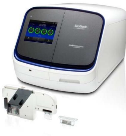
Applied Biosystems™基因分析仪以可靠性和值得信赖的结果为立足点。作为 Applied Biosystems™毛细管电泳(CE)基因分析仪产品系列的最新成员，SeqStudio 基因分析仪同样基于这一理念，但同时又追求易用、易维护，易于存取和便于分享数据。其先进特性在于将 Sanger 测序和片段分析的可靠性，与远程监控 和云应用便利性结合在一起。
