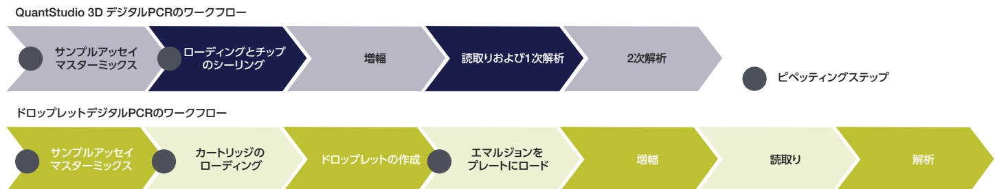
図2. チップベースのデジタルPCRワークフロー：ドロップレットベースのワークフローと比較すると、よりシンプルで安定しています。QuantStudio 3D チップベースデジタルPCRワークフローのピペティングのステップは最小限であり、一度チップをクローズしてしまえば完全にシールされます。一方、ドロップレットベースのアプローチでは、より多くのピペティングステップや溶液の移しかえステップがあり、サンプルのコンタミネーションがおこる恐れも高くなります。
