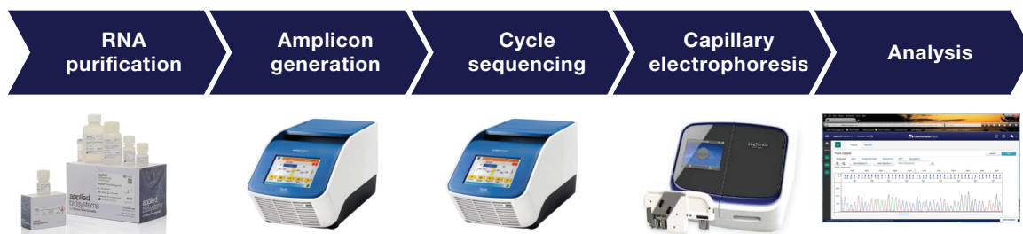
図1. サンガーシーケンスを用いたSARS-CoV-2系統検出のためのワークフロー
