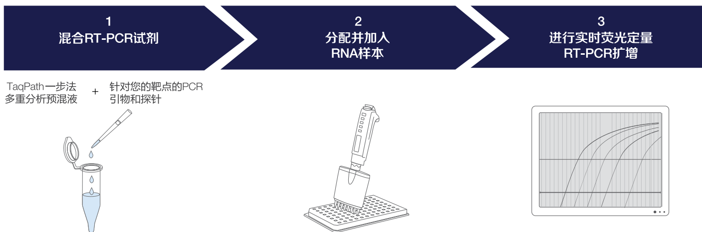
图1. 使用TaqPath一步法多重分析预混液的RT-qPCR工作流程。
