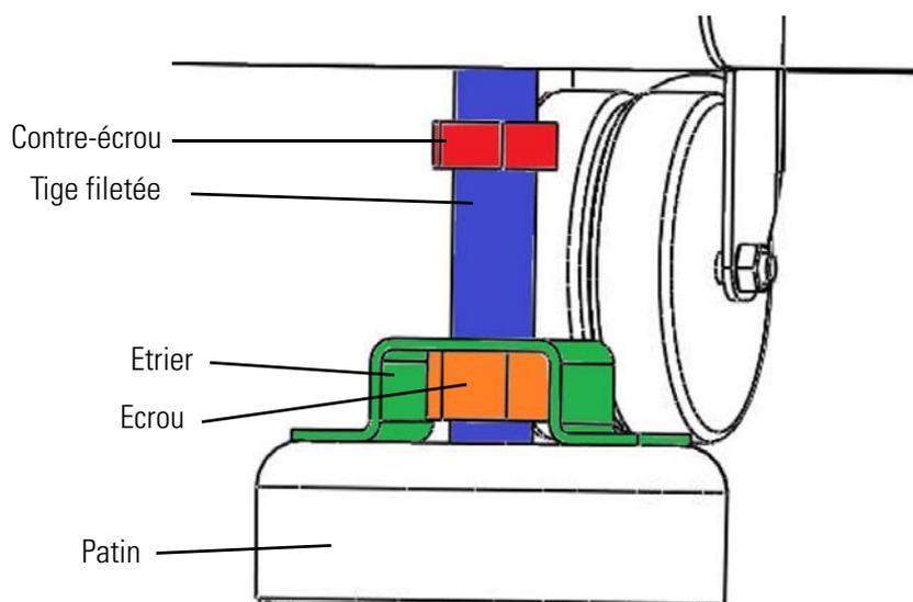
4. En tournant l'écrou, faites sortir complètement la tige filetée. Si vous ne faites pas cela, la centrifugeuse peut ne pas être sortie de la palette.
