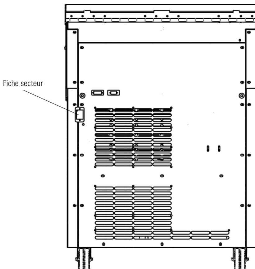
Figure 2-1. Raccordements au secteur
