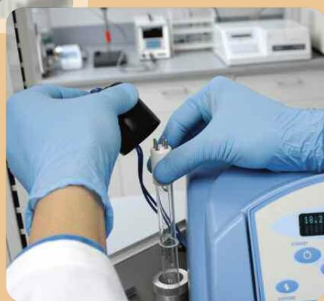
La sostituzione della lampada UV protegge il sistema dai microrganismi e ossida i composti organici nell'acqua di alimentazione consentendo di ottenere livelli del TOC inferiori a 5 ppb.
