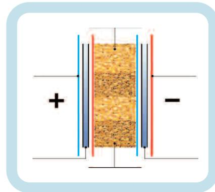
**L'elettrodeionizzazione, EDI**, abbina due valide tecnologie per ottenere acqua ultrapura, elettrodialisi e scambio ionico. A differenza dello scambio ionico convenzionale, in cui è possibile rigenerare chimicamente le resine o smaltire la cartuccia, l'EDI utilizza una corrente elettrica per la rigenerazione continua delle resine.
