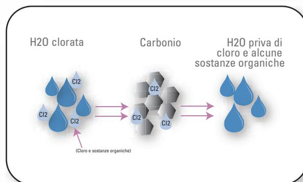
L'acqua di alimentazione contenente contaminanti organici e cloro viene a contatto con il carbone attivo all'interno della cartuccia. Le impurità aderiscono alla superficie del carbone, consentendo la produzione di acqua purificata.
