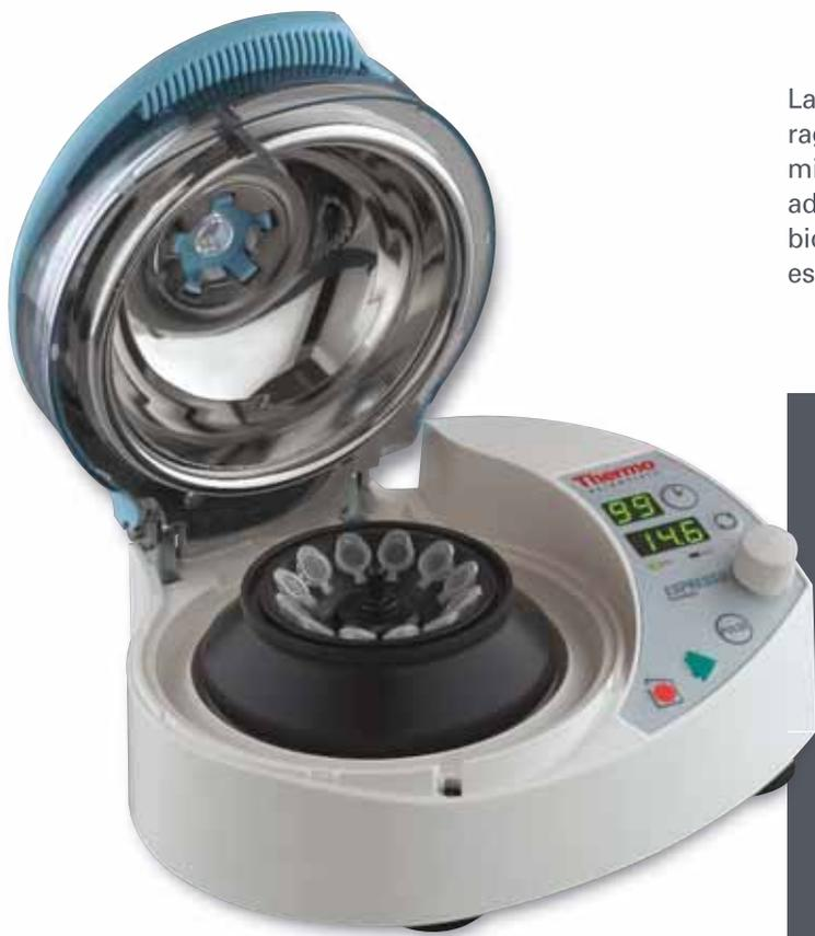
La centrifuga Espresso Thermo Scientific dotata di rotore da 12 posti raggiunge una velocità massima di 14.600 giri/min (14.500 xg) per microtubi da 1,5/2,0 ml o volumi inferiori sino a 0,5 ml con gli opportuni adattatori. Ideale per le applicazioni nei settori farmaceutico, delle biotecnologie e ricerca, la centrifuga Espresso, versatile e compatta, esegue cicli di centrifugazione standard con minime regolazioni.
