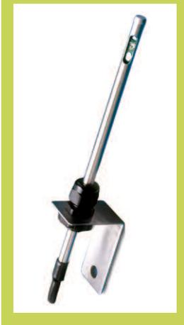
Il est également possible d'utiliser un **anémomètre, ou « fil chaud »** pour procéder à des mesures de flux d'air. Cet appareil utilise un fil chaud pour mesurer la vitesse de sorte que plus il est au contact de l'air, plus il refroidit, ce qui modifie sa résistance électrique. Certains anémomètres déclenchent une alarme sonore ou visuelle en cas de déviation du flux d'air, mais ne mesurent qu'un seul point du flux d'air.
