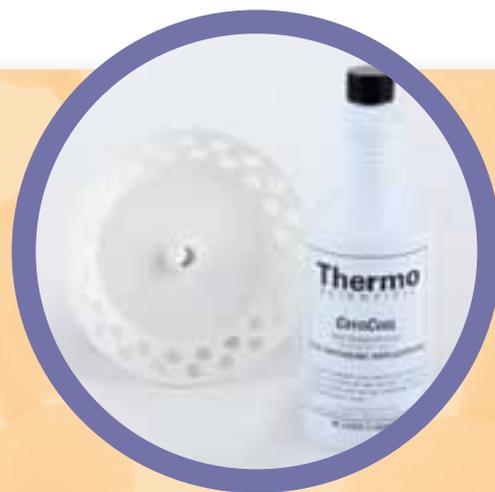
O kit SPD1010 P1 SpeedVac inclui um rotor de 40 x 1,5 mL e uma garrafa de 1 L de fluido de transferência de calor CryoCool
