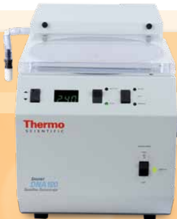
Il kit SpeedVac Savant DNA120 include un rotore da 36 x 1,5 ml
