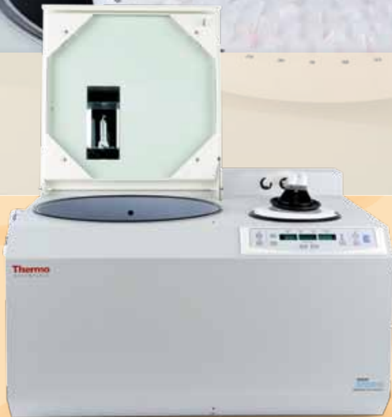
Il kit SpeedVac SPD2010 P1 include un rotore da 200 x 1,5 ml e bottiglia da 1 l di liquido per lo scambio di calore CryoCool
