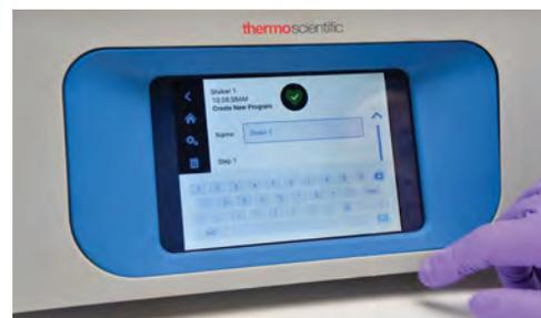
Les utilisateurs peuvent facilement programmer la vitesse et l'heure des agitateurs orbitaux Solaris pour optimiser leurs ressources et assurer l'homogénéité des opérations d'exécution.
