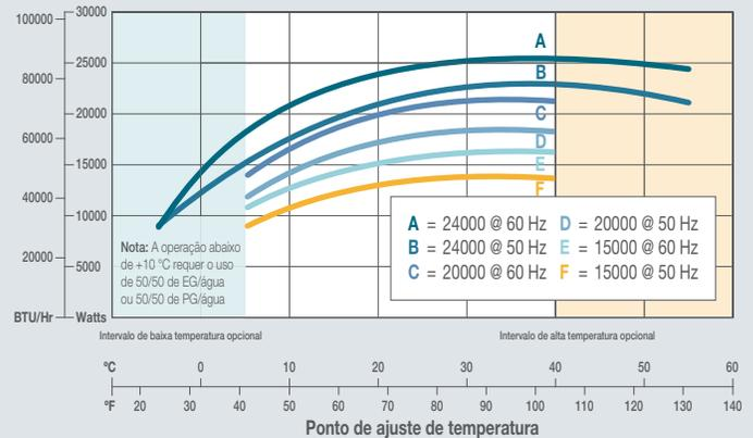
Capacidade de resfriamento com base em bombas P3 configuradas a 10 gpm.
