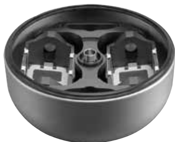
Rotor basculante HIGHPlate 6000, 90°, R máx. 139 mm
