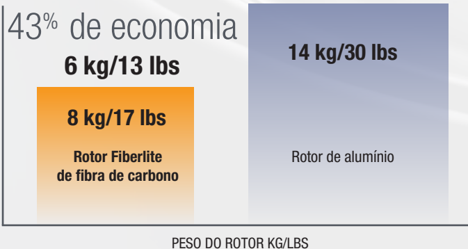
Figura 1: menos peso com os rotores de fibra de carbono.
