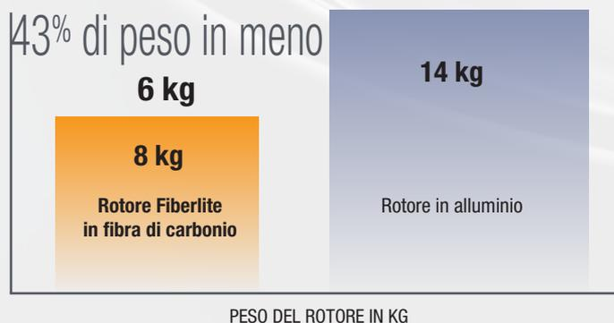
Figura 1: confronto in termini di peso tra rotore in fibra di carbonio e rotore in alluminio.
