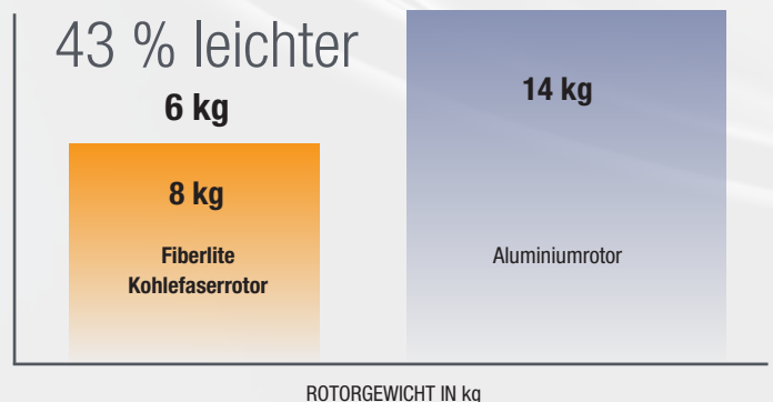
Abbildung 1: Gewichteinsparung mit Kohlefaserrotoren
