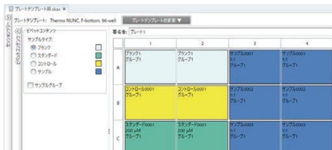
操作性のよい選択ツールにより、プレートレイアウトでサンプルを簡単に設定可能
