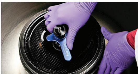
革新的なスピードハンドルによりローターリッドをスピーディかつ安全に締め込むことが可能です。またドライブシャフトからのローターの取り外しも容易です。
