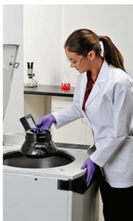
1. 遠心チャンバー内のドライブシャフトにローターを装着
