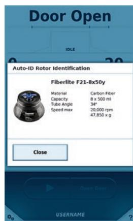
2. ローターは直ちに遠心機システムに識別され、パラメーターもロード
