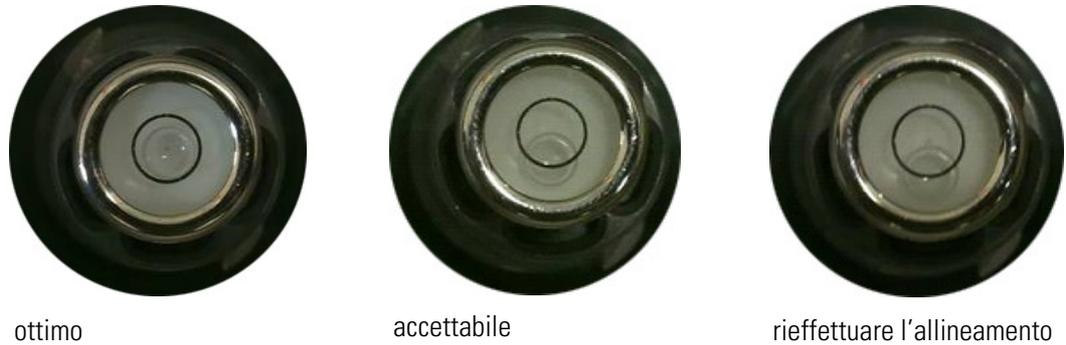
**Figura 6.** Posizione della bolla d'aria nella livella
