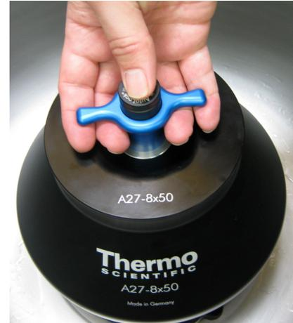
**Ilustração 14.** Posição das mãos na desmontagem do rotor
