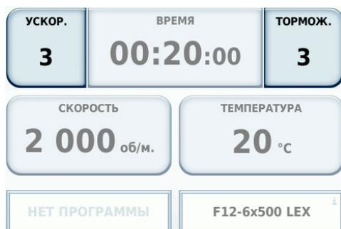
Рисунок 10. Ввод профилей ускорения и замедления
