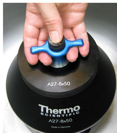
Рисунок 14. Положение рук при демонтаже ротора
