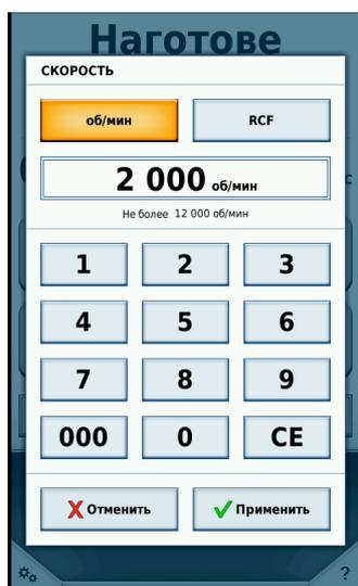
Рисунок 11. Экран для задания частоты вращения и значения ОЦУ
