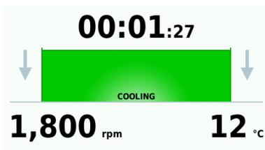
Der Rotor ist eingesetzt, der Zentrifugendeckel ist geschlossen; die Vortemperierung wird durchgeführt. Die Restlaufzeit des Kühlvorgangs wird angezeigt (siehe „Vortemperierung“ auf Seite 16).
