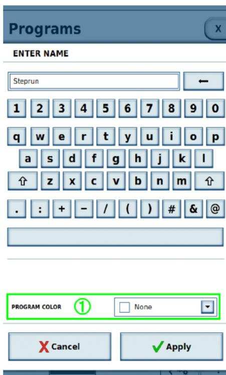
Unterhalb der Bildschirmtastatur kann dem Programm ein Barcode und eine Farbe zugewiesen werden ①. Der Barcode kann im GMP-Modus verwendet werden, um das Programm per Barcode-Scanner auszuwählen. Die ausgewählte Farbe erscheint in der Programmübersicht und in der Detailansicht. Die Zuweisung einer Farbe ist optional und dient dem leichteren Erkennen des Programms. Die Liste der verfügbaren Farben ist vorgegeben und kann nicht angepasst werden.
