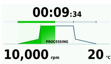
Der Zentrifugationslauf läuft mit der eingestellten Drehzahl. Die Restlaufzeit des Zentrifugationslaufs wird angezeigt.
