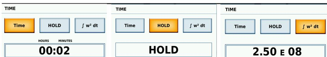
Wird die Zeit während einer laufenden Zentrifugation geändert, startet die Zeitmessung erneut. Die schon verstrichene Zeit wird dabei nicht berücksichtigt und die Beschleunigungsphase entfällt.
