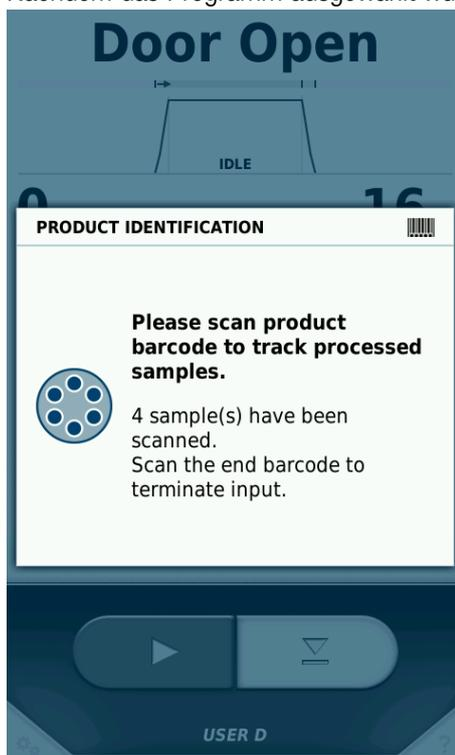
Wurden alle Seriennummern erfasst, kann die Eingabe durch Scannen des vordefinierten Barcodes ENDE beendet werden.
