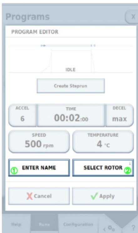
Durch Tippen auf **Name eingeben** ① öffnet sich ein Fenster, um den Namen des Programms mit Hilfe einer Bildschirmtastatur einzugeben.
