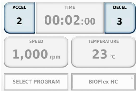
Nach Betätigen der jeweiligen Schaltfläche öffnet sich ein Fenster, in dem das gewünschte Profil durch Verschieben eines Reglers ausgewählt werden kann. Alternativ kann das gewünschte Profil auch direkt durch Antippen ausgewählt werden. Mit Berührung der Schaltfläche **Anwenden** wird die Auswahl für den nächsten Zentrifugationslauf festgelegt und mit **Abbrechen** wird die Auswahl verworfen.
