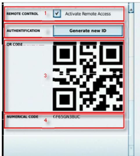
1. Fernsteuerung: Kontrollkästchen zum Freigeben/Sperren der Option Fernsteuerung (Master-Passcode erforderlich).
