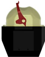
3. Drücken Sie den Bügel nach unten, um den Becher aerosoldicht zu verschließen. Stellen Sie sicher, dass der Bügel hörbar einrastet.
