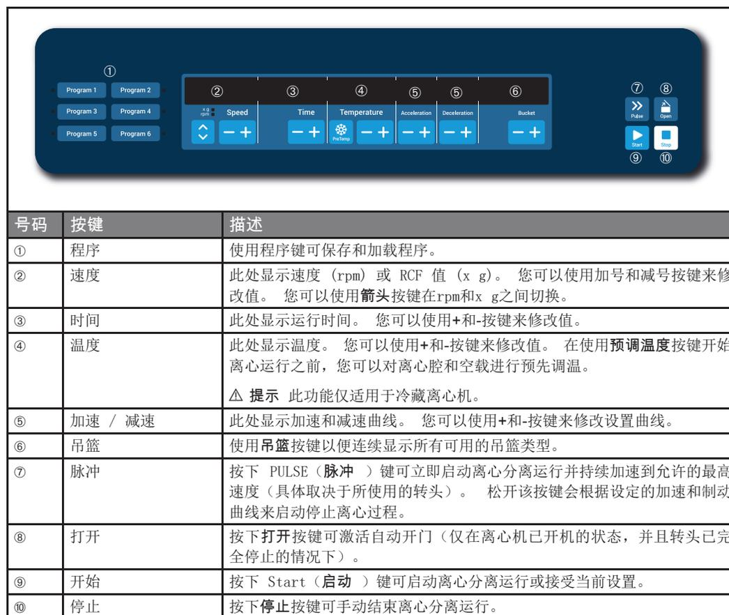
图 3-1: LCD控制面板上的功能
