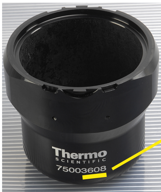
Figură 3–8: Setarea codului corect al cupei pentru rotor
