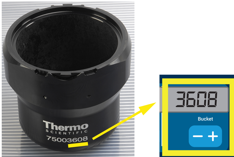
図 3-8: ローターの適切なバケットコードの設定
