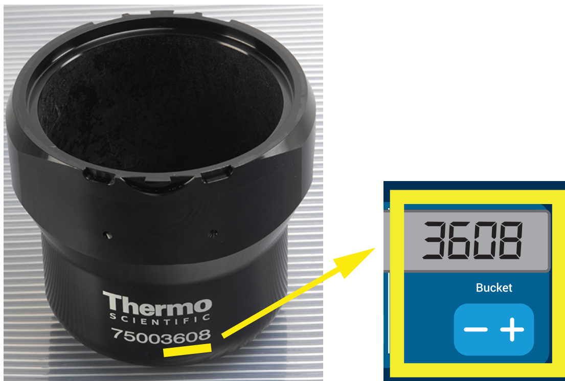
図 2-18: 適切なバケットコードの設定
