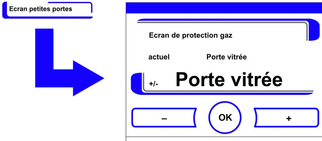
**Figure 6-39.** Réglage des portes internes étanches au gaz
