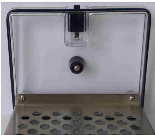
3. Insérer un nouveau joint dans l'encoche en veillant à ce que la lèvre du joint soit à l'extérieur.
