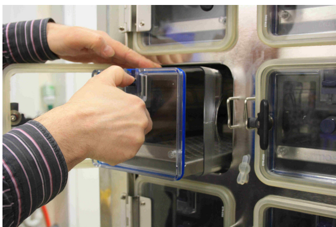
Accesso ai campioni all'interno della camera con pannello frontale trasparente
