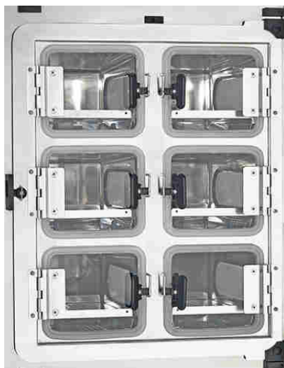
Schermo a tenuta di gas a 6 antine per CELL LOCKER
