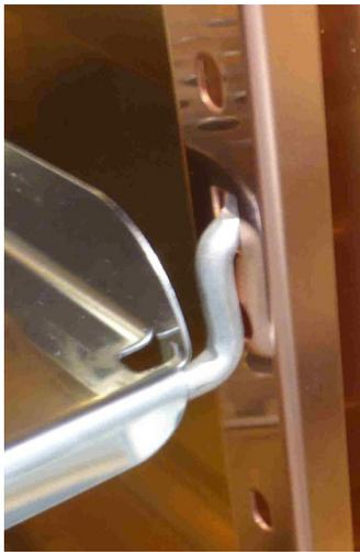
Figura: Instalación de las bandejas perforadas
