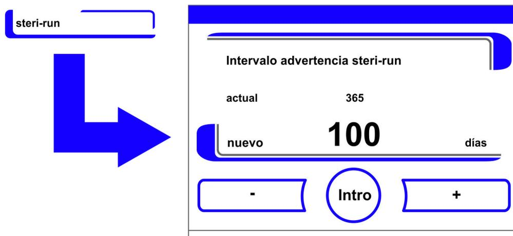
**Figura 6-30.** Ajustar el intervalo de recordatorio para Steri-run
