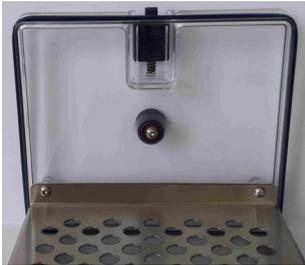
3. Introduzca una junta nueva en la ranura, prestando atención a que el labio de la junta esté en el exterior.
