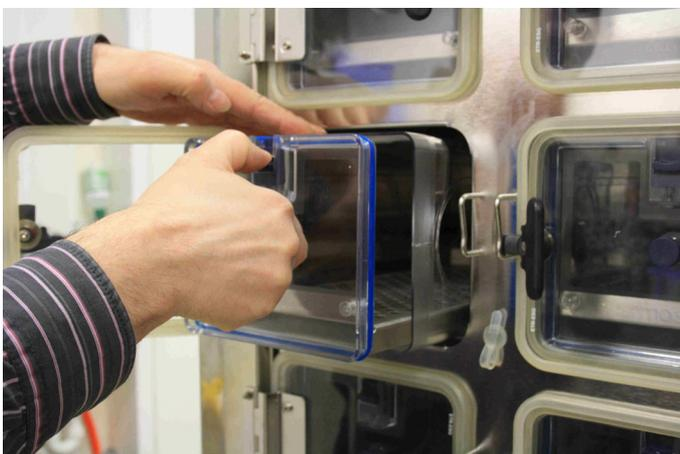
acceso a las muestras dentro de la cámara con cubierta de transporte
