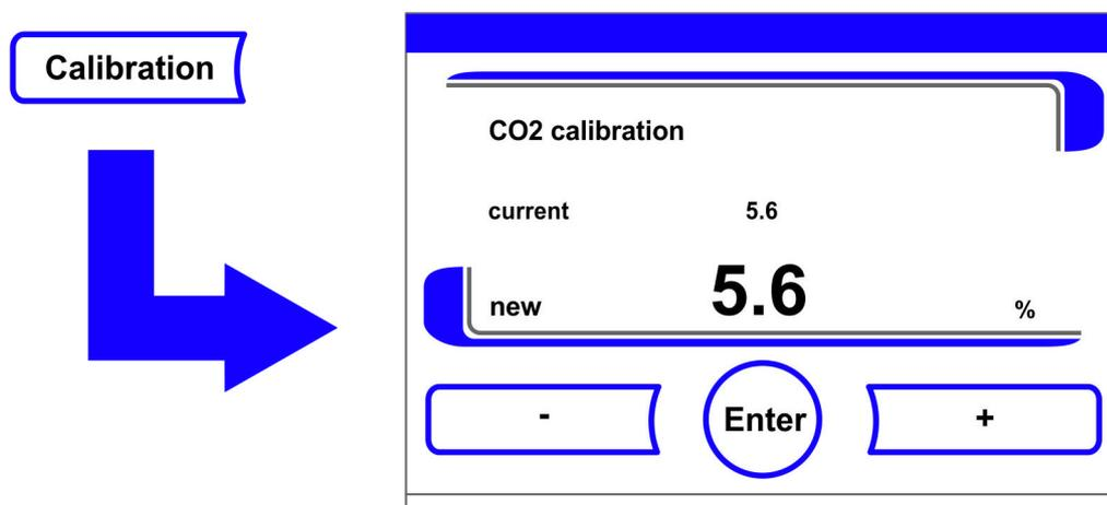
Рисунок 9-5. Калибровка датчика концентрации CO<sub>2</sub>
