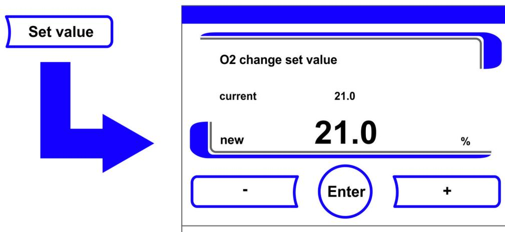
Рисунок 6-12. Настройка уставки концентрации O<sub>2</sub>
