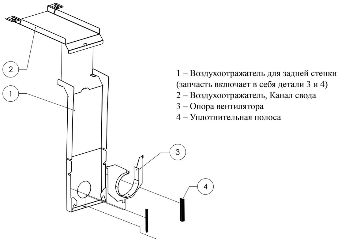
**Рисунок 4-4.** Детали направляющей воздушного потока **STERI-CYCLE i160 LK**
