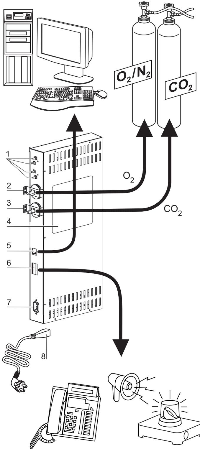
Рисунок 3-9. Соединения устройства (правая сторона блока управления)
