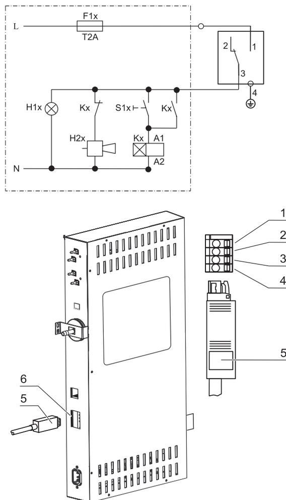
Рисунок 4-16. Пример соединения аварийного контакта
