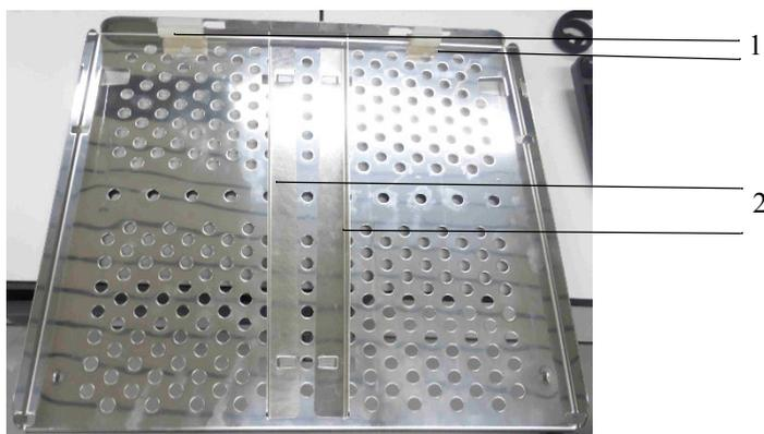
Рисунок: Перфорированные полки с односторонними направляющими
