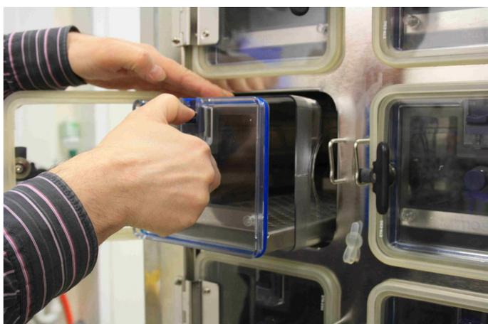
Доступ к образцам в камере с использованием прозрачной передней панели
