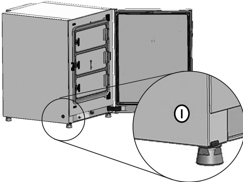
Рисунок 6-1. Сетевой выключатель
