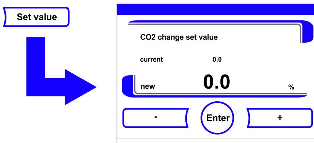
Рисунок 6-10. Настройка уставки концентрации CO<sub>2</sub>
