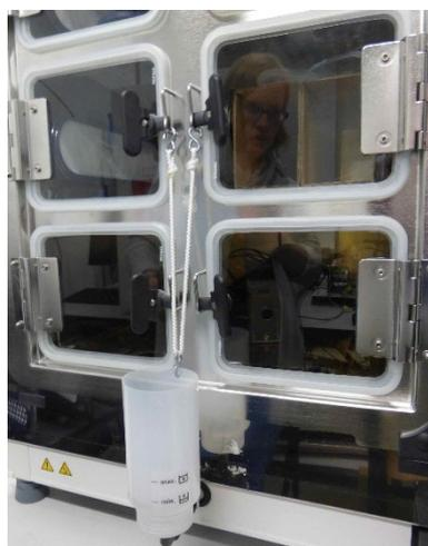
**Рисунок 5-3.** Доливная воронка
