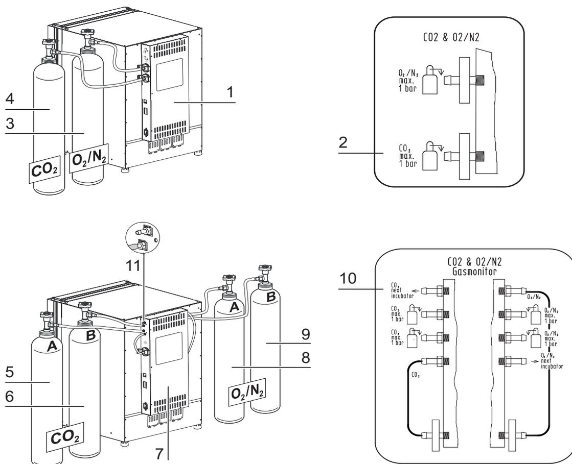
Рисунок 3-2. STERI-CYCLE i160 LK / i250 LK, вид сзади
