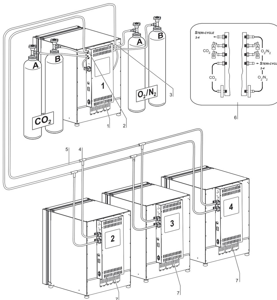
**Рисунок 3-3.** Обводное газоснабжение для **STERI-CYCLE i160 LK / STERI-CYCLE i250 LK**
