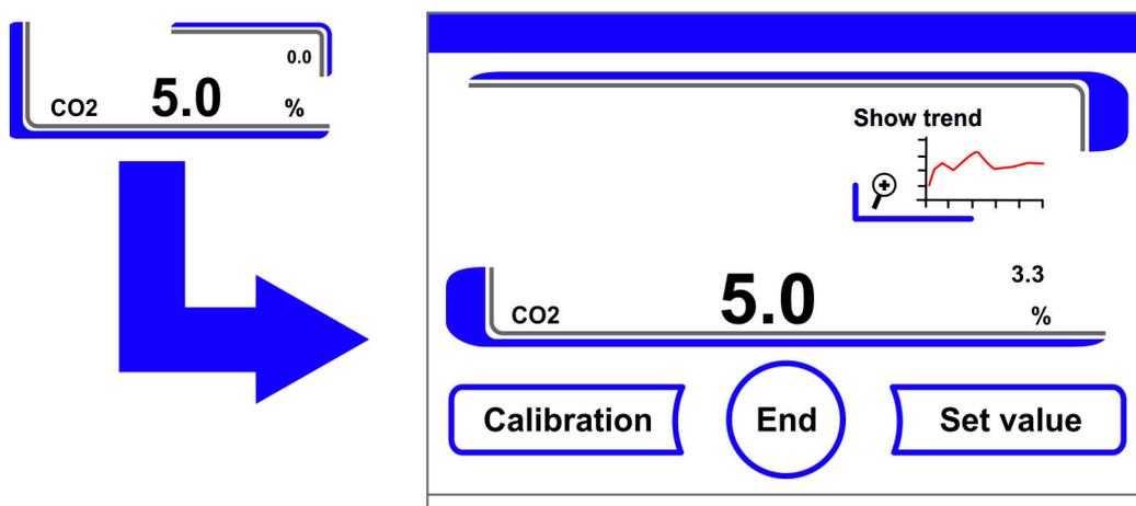
Рисунок 6-9. Индикаторное поле CO<sub>2</sub> и меню CO<sub>2</sub>
