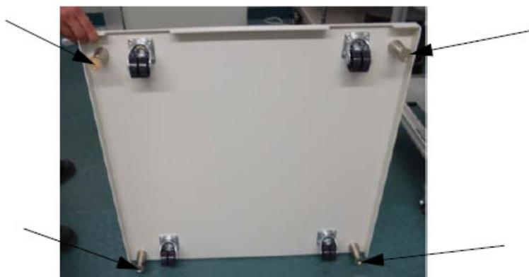
Рисунок 2-9. Опорные ножки
