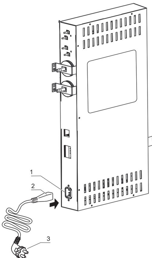
Рисунок 4-15. Подключение сетевого питания
