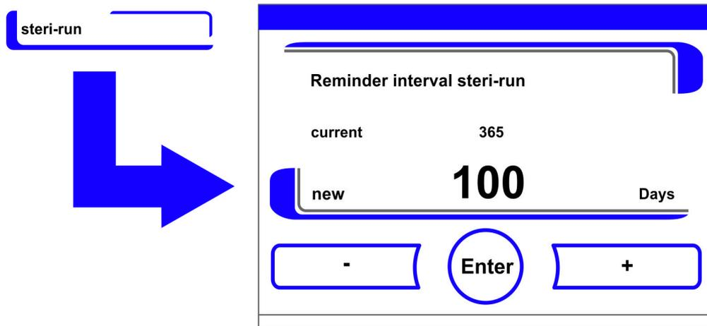
Рисунок 6-30. Настройка интервала предупреждения для программы steri-run
