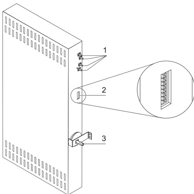
**Рисунок 3-10.** Опциональные разъемы устройства (левая сторона блока управления)
