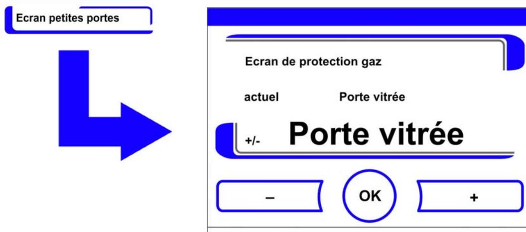
Figure 6-39. Réglage des portes internes étanches au gaz
