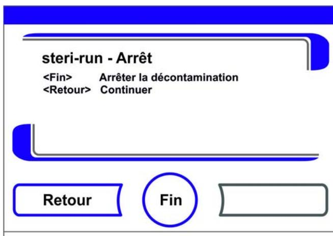
**Figure 8-7.** Interruption et annulation de la procédure Steri-Run
